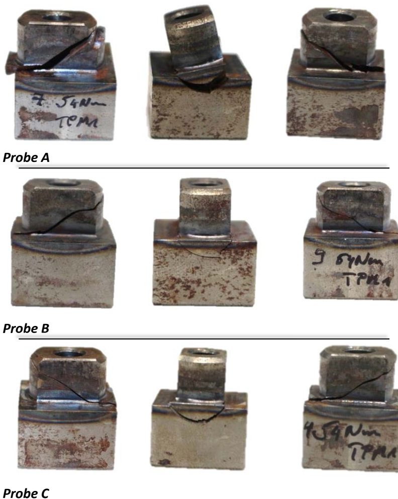
Abbildung 6.19: Vollständig durch Restbruch abgescherte Proben
