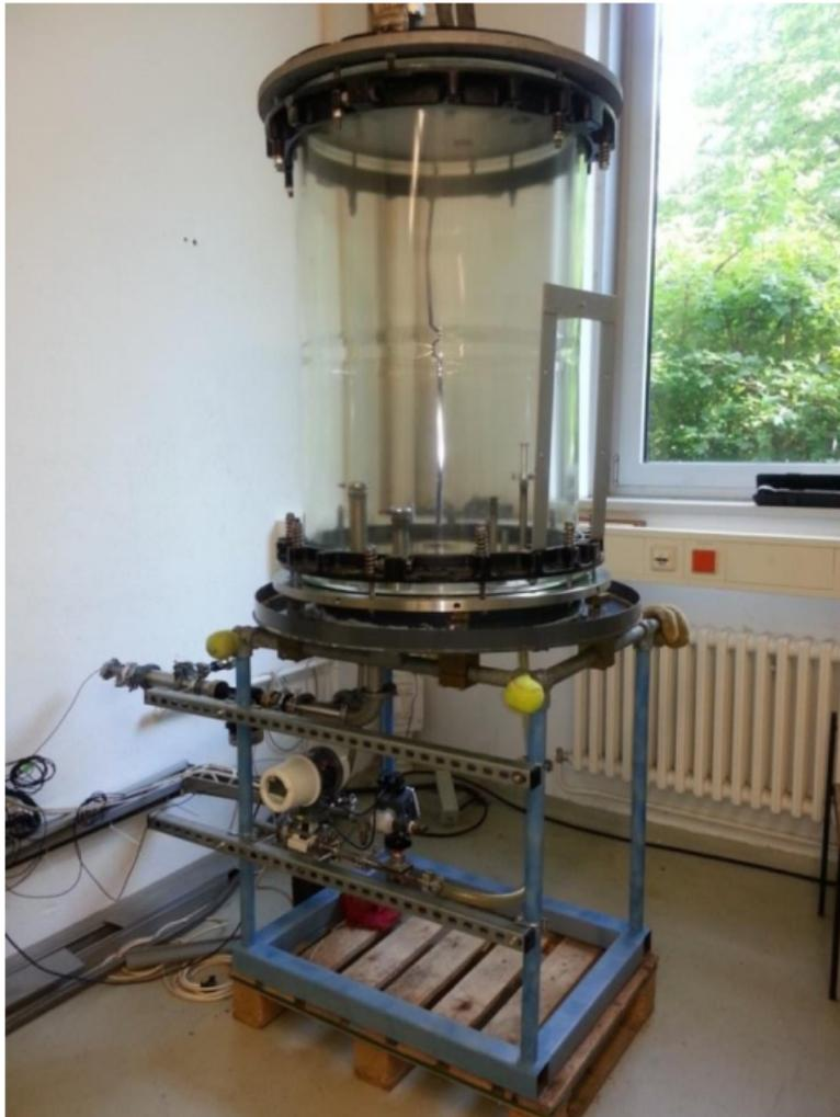
Abbildung G.2: Foto des Pumpenteststands, Quelle: Romanski, 2015
