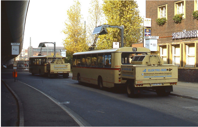
Abbildung 2.2. Elektrobuse MAN SL-E der Rheinbahn an Pantographen-Ladestation, ca. 1980 (Quelle: Horst Lüdicke, bus-bild.de ; mit freundlicher Genehmigung)
