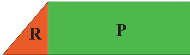
Abbildung 5.4: Schematische Darstellung der Plasmadichte im x-Raum vor der Wechselwirkung mit dem Laserpuls. P ist das Hauptplasma mit einer Dichte  $n_e > n_k$ , R stellt die Plasmarampe mit linear ansteigender Dichte bis  $n_e$  dar.
