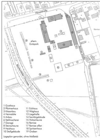
Lageplan Stadtgut Blankenfelde (Umzeichnung Spiegel). Die grau angelegten Bauten sind Bestandteil des Denkmalsbereichs.
