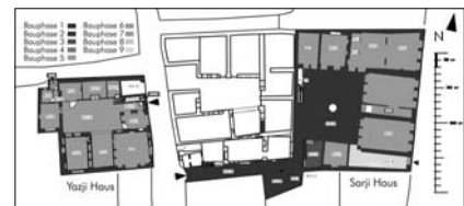
Bauphasen der Häuser Yazji und Sarji, Dezember 2007.
