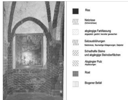
Stendal, St. Marien, Schadenskartierung der Wand d. auf Grundlage einer photogrammetrisch entzerrten Wandansicht, 2007.
