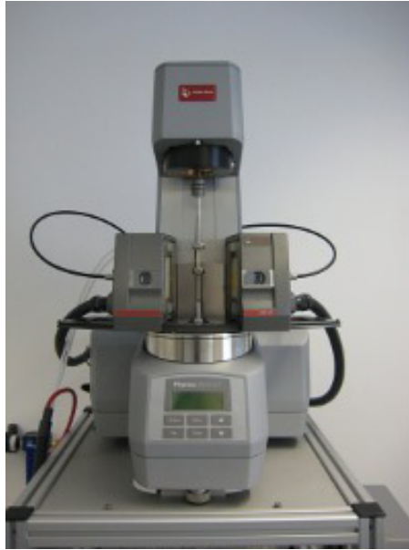
Abbildung 16: Kapillarausfluss-Viskosimeter der Firma Anton Paar, Österreich (Foto Internet)
