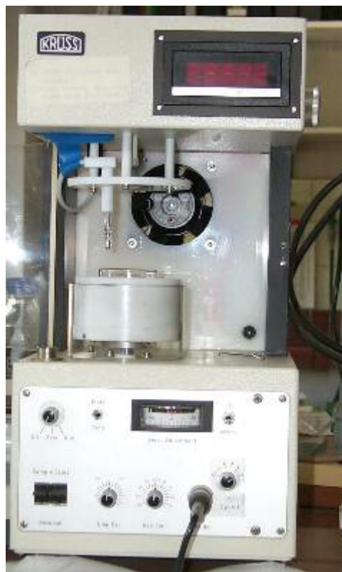
Abbildung 14: Digital-Tensiometer der Firma Krüss/ Hamburg (eig. Foto)
