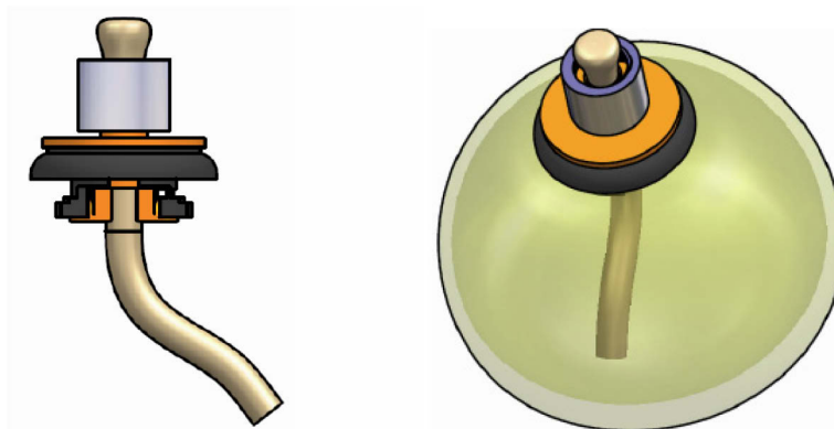
Abbildung 24: BfR-BAM Konstruktionsvorschlag für Sicherheitsöllampen nach DIN 14059 (Hahn A, 2010)
