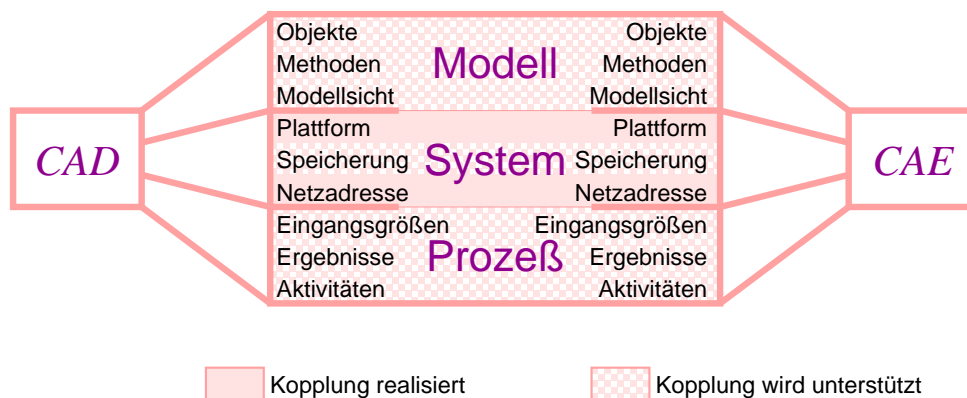
Bild 6.19: Anforderungen, die bei Verwendung von CORBA erfüllt werden können
