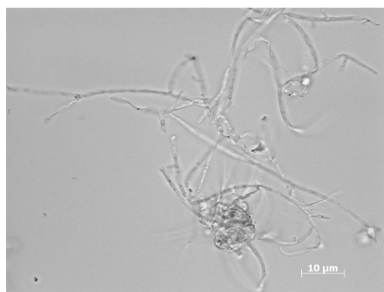
Abbildung 12: Lichtmikroskopische Analyse der Schwimmschichtprobe aus Reaktor 2 bei einer 100x Vergrößerung. Filamentöse Strukturen in der Schwimmschicht.
