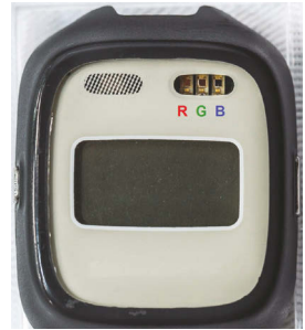
Abbildung 1: Foto eines Actiwatch Spectrum-Detektors mit drei optischen Sensoren für den roten (R), grünen (G) und blauen (B) Spektralbereich.
