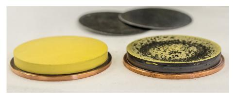
Abb. 16: Neues und gebrauchtes In<sub>2</sub>O<sub>3</sub>-Target nach ca. 50 h Brenndauer (2"-Durchmesser).
