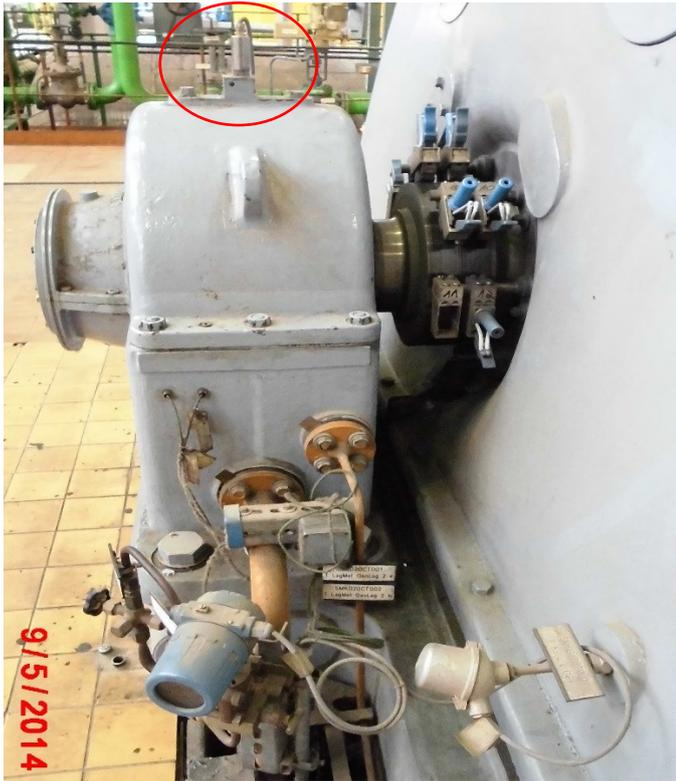
*Abbildung 76: Stehler mit Schwingungsaufnehmer in vertikaler Richtung*
