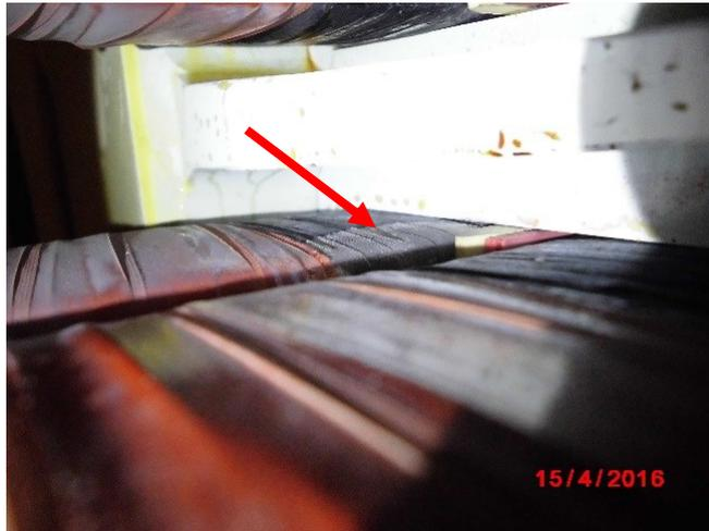
Abbildung 57: Geschädigter Stab der Unterlage
