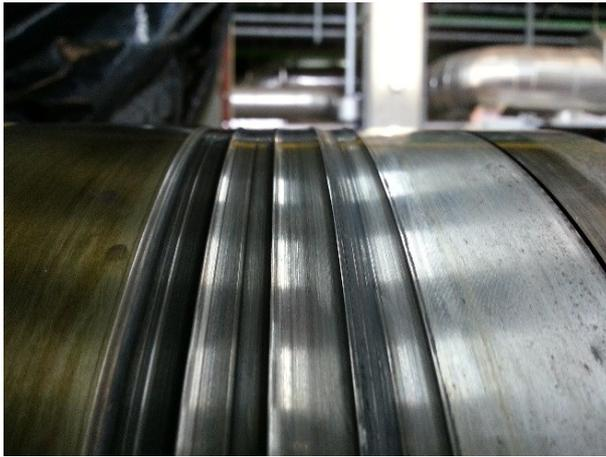
*Abbildung 65: Eingelaufene Welle im Bereich der Ölabstreifer*
