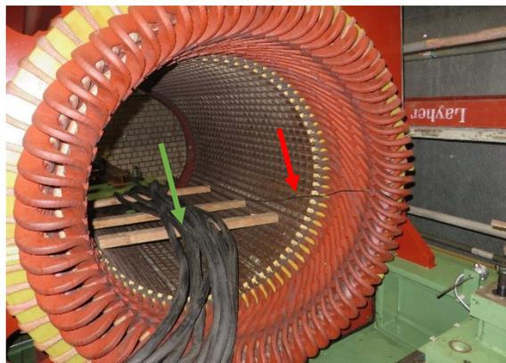
Abbildung 31: Stator mit eingebrachter Erregerspule bei einer Magnetisierungsprüfung
