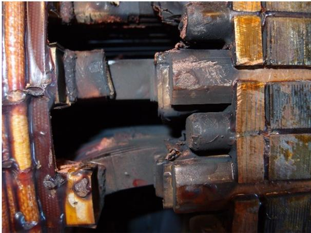
*Abbildung 68: Durchschlagstelle an der Rotorwicklung*
