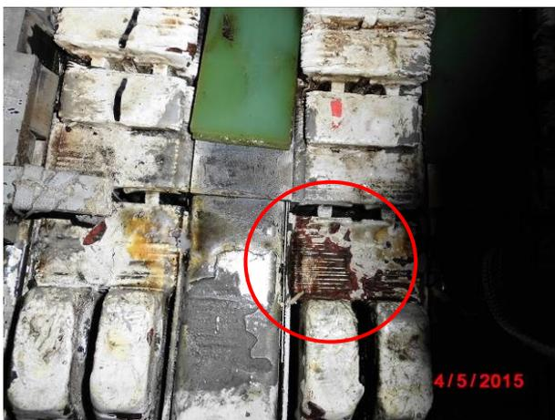
Abbildung 64: Eisenbrand am Blechpaket
