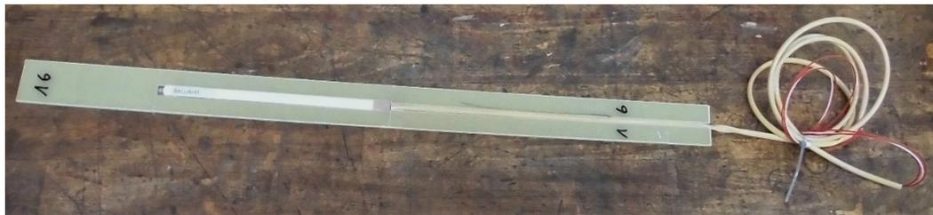
Abbildung 16: Pt 100 Temperaturfühler für einen 500 MW - Stator (Elektrosila)
