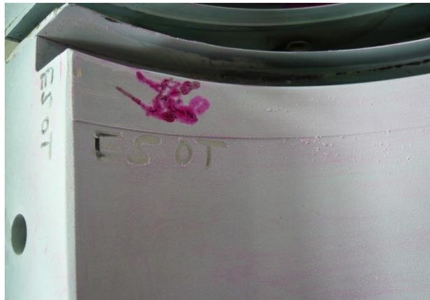
*Abbildung 17: Gleitlager - Oberlagerschale mit Anzeige bei der Farbeindringprüfung*
