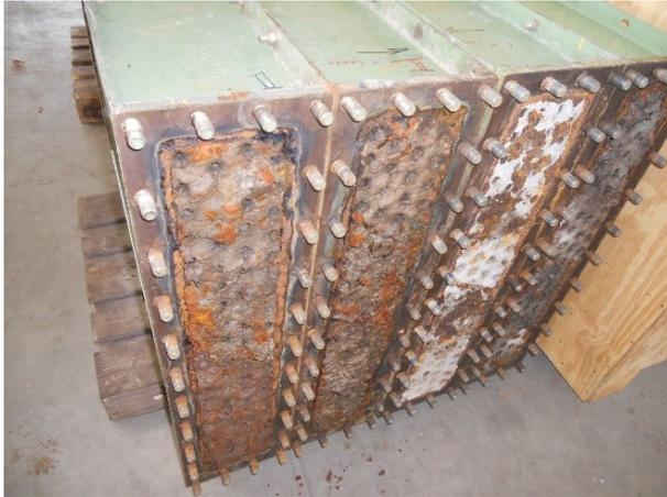
*Abbildung 69: Stark beschädigter Wärmetauscher*
