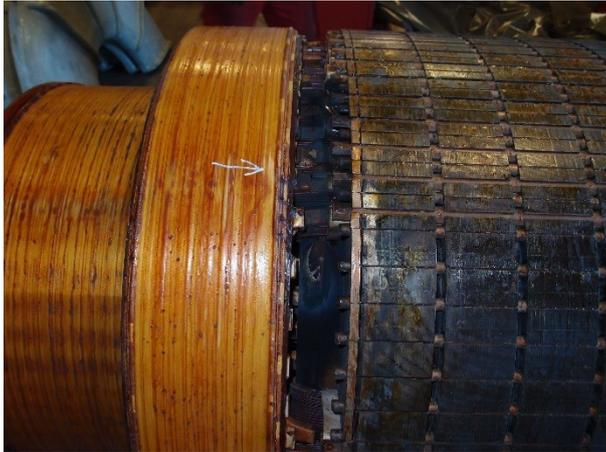
*Abbildung 67: Geschädigter Rotor*
