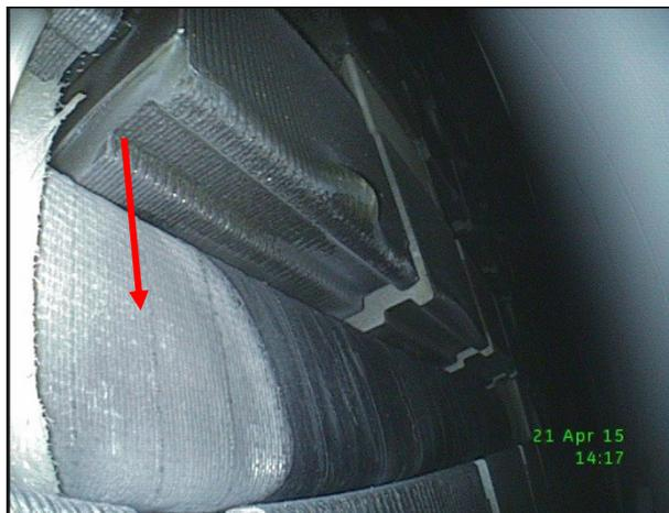
Abbildung 52: Endoskopiebild mit Schaden am Außenglimmschutz eines Oberlagestabes
