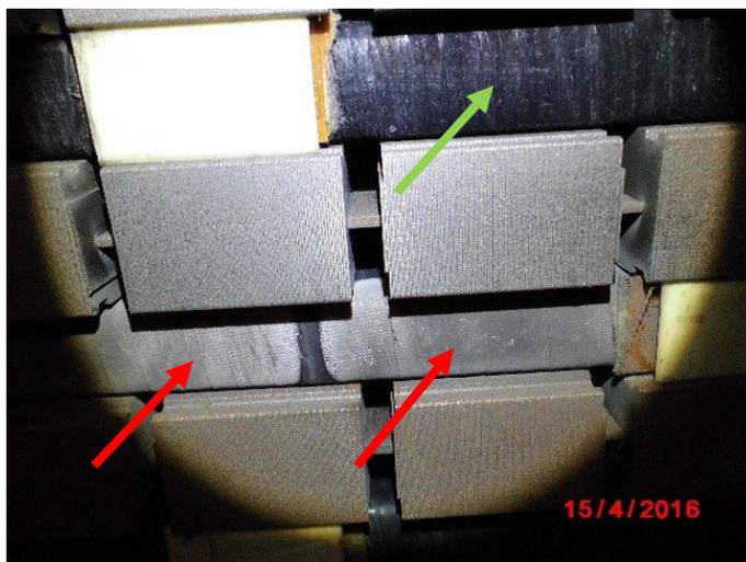
Abbildung 54: Geschädigter Oberlagestab
