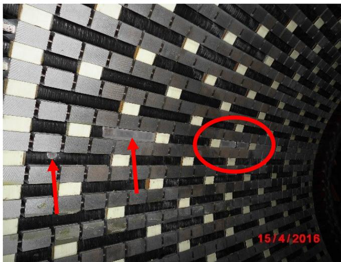
Abbildung 56: Stator-Blechpaket und geschädigte Wicklung
