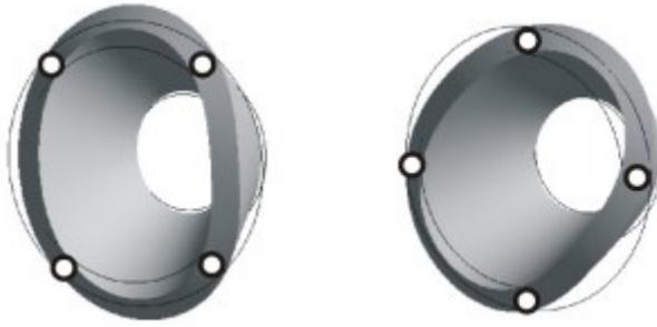
Abbildung 14: 4 Knoten-Modell für einen zweipoligen Generator [62]
