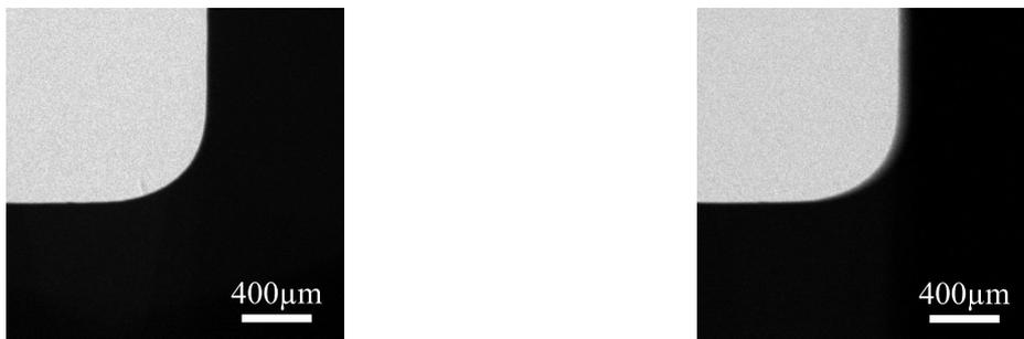
**Abbildung 4.4.5:** Projektion einer Kante zur Abschätzung der Quellgröße in x-Richtung und y-Richtung. Elektronenstrahlposition Links:  $0\ \mu\text{m}$ . Rechts:  $60\ \mu\text{m}$ . Man beachte die unterschiedliche Breite des vertikalen Kantenübergangs in den Bildern.
