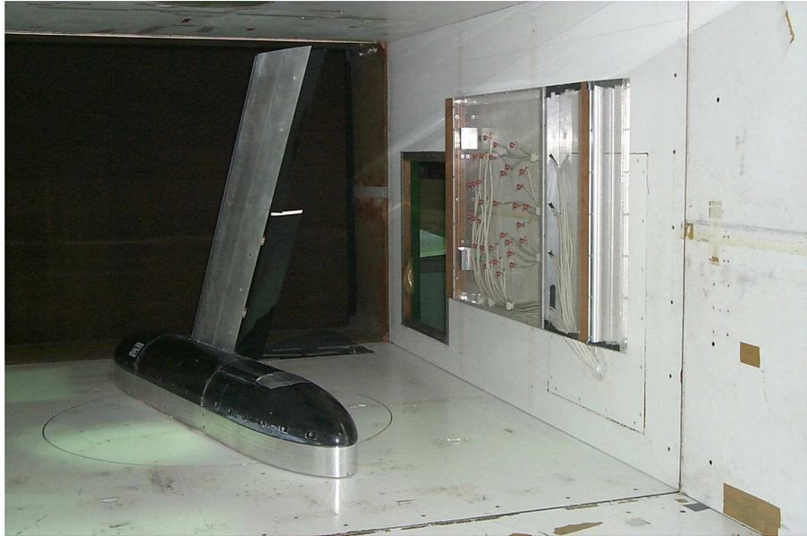
Abbildung B.13: Photo des SCCH-Modells mit dem kleinen Mikrofon-Array in der Messstrecke.
