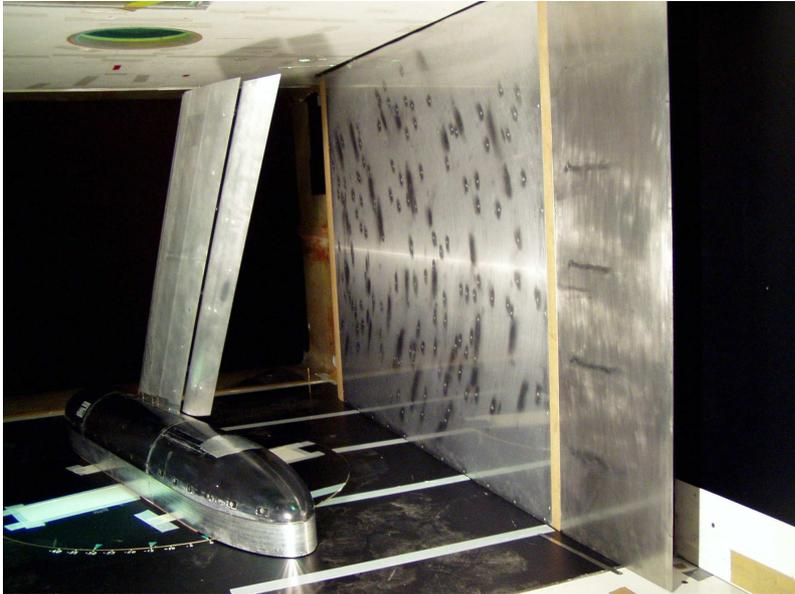
Abbildung 4.8: Photo des großen Mikrofon-Arrays und des SCCH-Modells in der Messstrecke.
