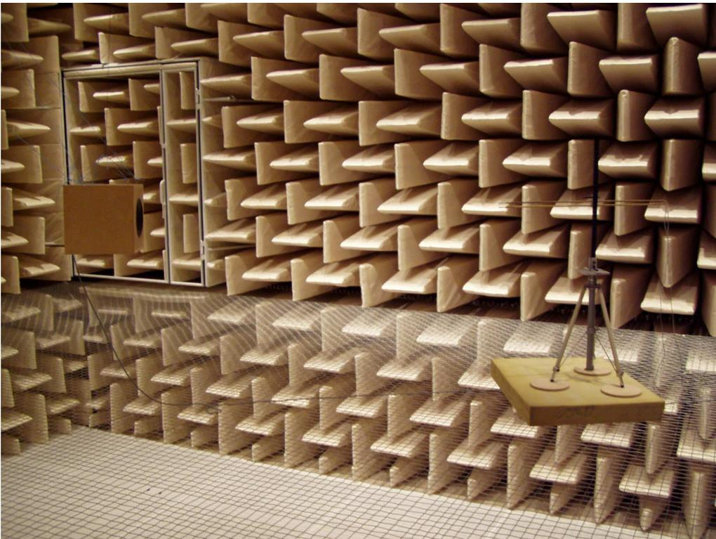
Abbildung B.18: Photo des reflexionsarmen Raumes. Die Lautsprecherbox ist 1 m über dem Laufnetz aufgehängt. Die Entfernung der Mikrofone zur Membran beträgt 2.0 m.
