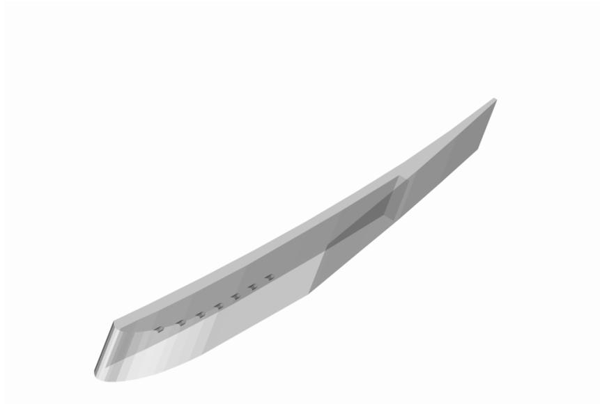
Abbildung 3.13: Der Abschlussdeckel für die Ausblaskonfiguration E551. Die Löcher befinden sich im vorderen Bereich der Seitenkante nur an der Saugseite-ecke.
