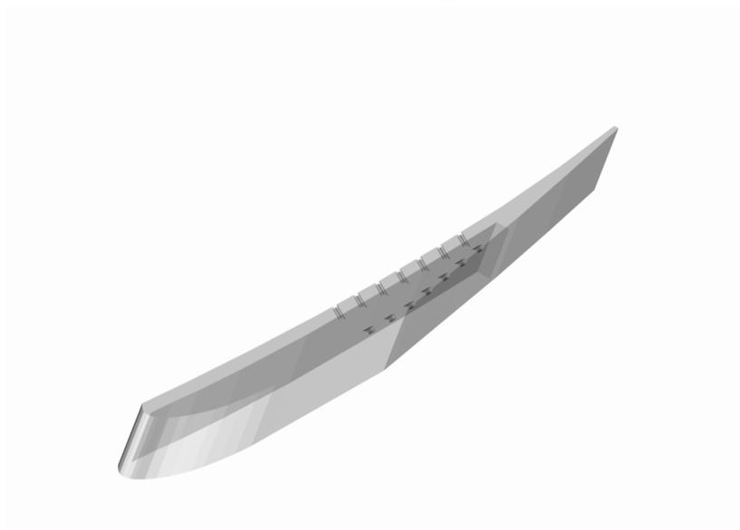
Abbildung 3.12: Der Abschlussdeckel für die Ausblaskonfiguration E521. Die Löcher befinden sich im hinteren Bereich der Seitenkante an der Saug- und der Druckseitenecke.
