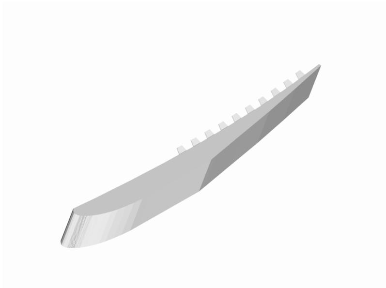
Abbildung 3.19: Der Abschlussdeckel mit Wirbelgeneratoren im hinteren Bereich der Seitenkante (E70x).
