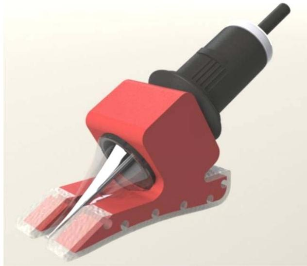
Abb. 4-89 Gleitfußadapters mit eingesetztem Stechmodul, CAD-Bild A. Loth, D. Scherkowski
