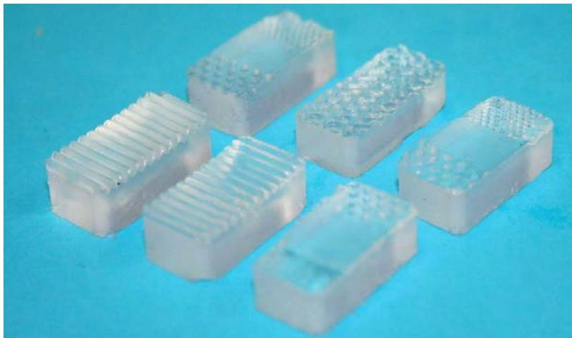
**Abb. 4-86** Detailfoto der für Reibversuche in Silikon abgeformten Reibstrukturen
