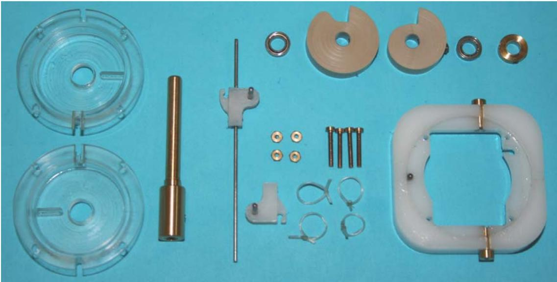
**Abb. 4-49 Einzelteile des Sprungaktor-Demonstrators vor der Montage**
