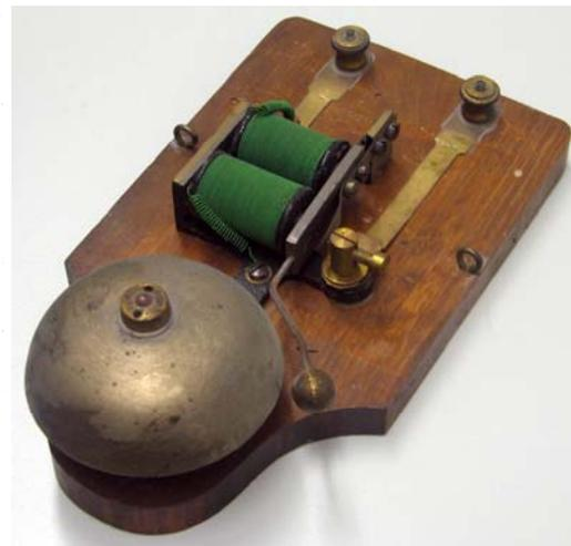
Abb. 2-12 Wagner-Hammer, links Zeichnung [WiWH10], rechts innerer Aufbau einer antiken Klingel
