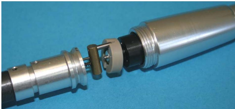
Abb. 2-25 Taumelscheibenantrieb eines zerlegten PMU-Geräts der Firma MT.DERM
