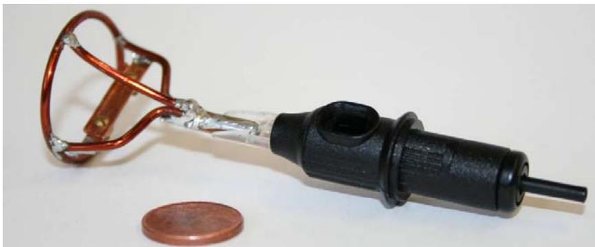
**Abb. 4-101** Durch Modifikation eines Tätowiermoduls aufgebautes Ringmodul mit festem Durchmesser und fest angebrachter Nadel
