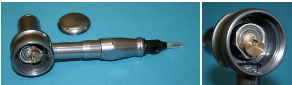
Abb. 2-19 Kurbeltrieb eines zerlegten Tätowiergeräts Cheyenne™ Condor der Firma MT.DERM, links in der Gesamtansicht, rechts der Kurbeltrieb im Detail
