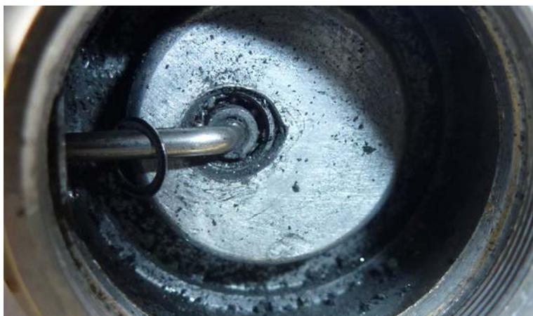
**Abb. 4-12 Innenraum eines Prototyps mit totalem Lagerschaden nach 250 Stunden Volllast-Betrieb**
