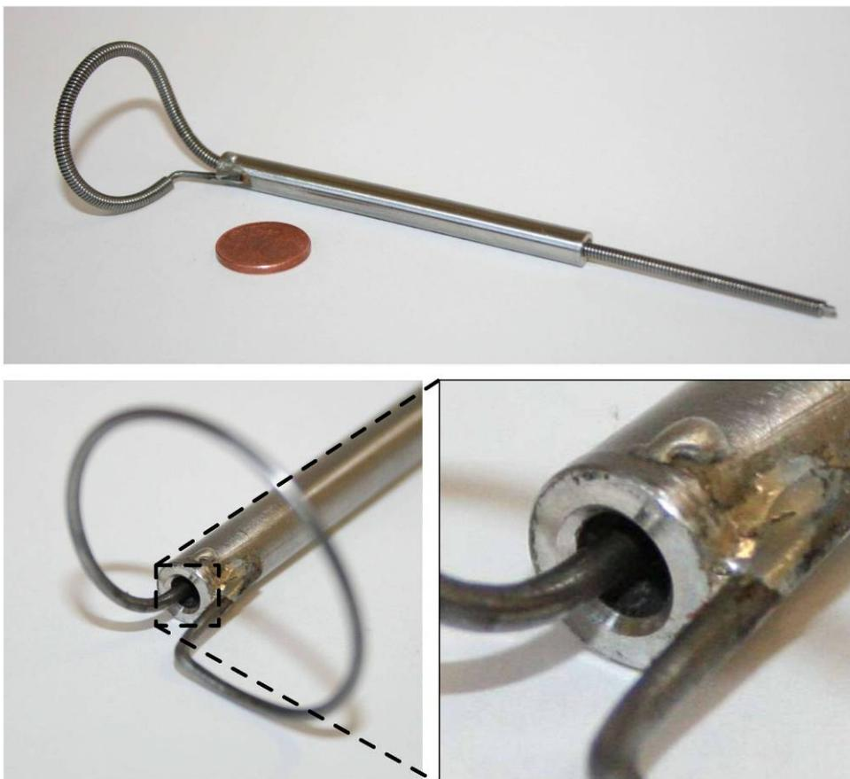
**Abb. 4-64** Fotos des experimentellen Ringfuß-Aktivspanners, oben eine Gesamt-, unten Detailansichten bei entfernter Federwelle
