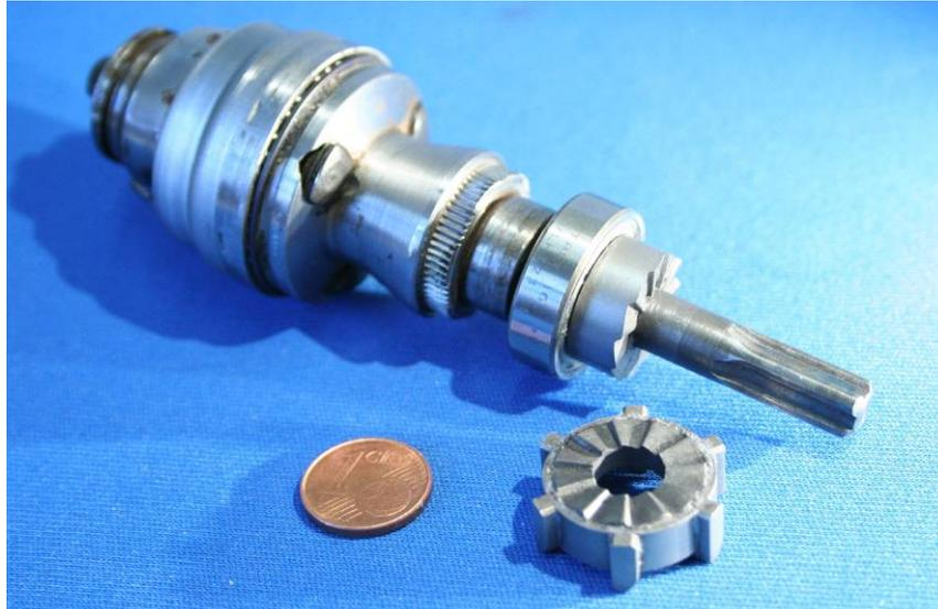
**Abb. 4-93 Demontiertes Schlagwerk eines Akku-Bohrschraubers**
