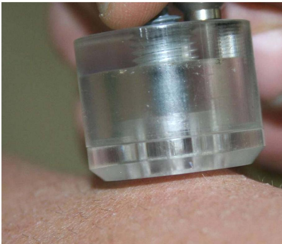
**Abb. 4-67** Demonstration zur Wirksamkeit der Vakuumdüse auch beim Anheben und seitlichen Verschieben
