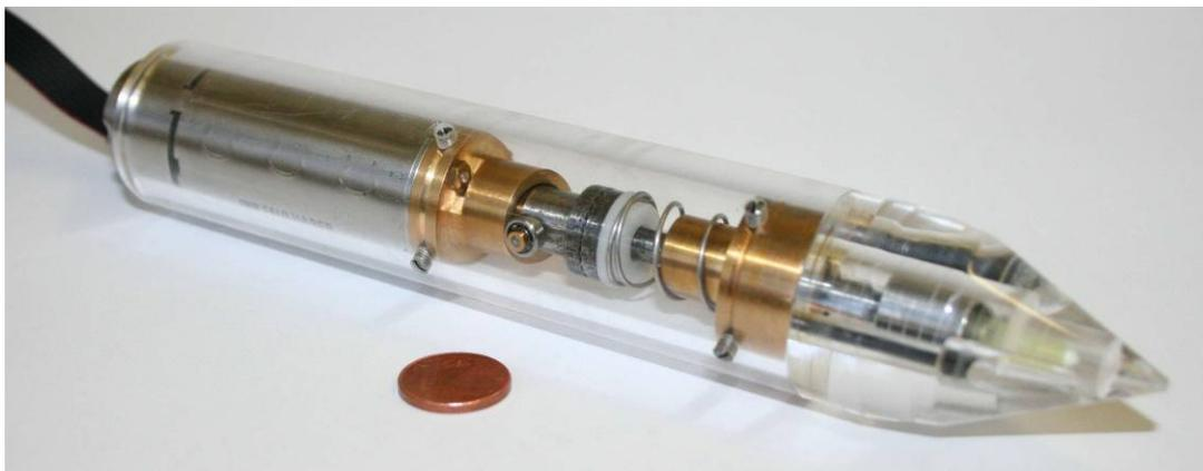
**Abb. 4-95** Schlagaktor, zur besseren Beobachtung in einem PMMA-Gehäuse aufgebaut
