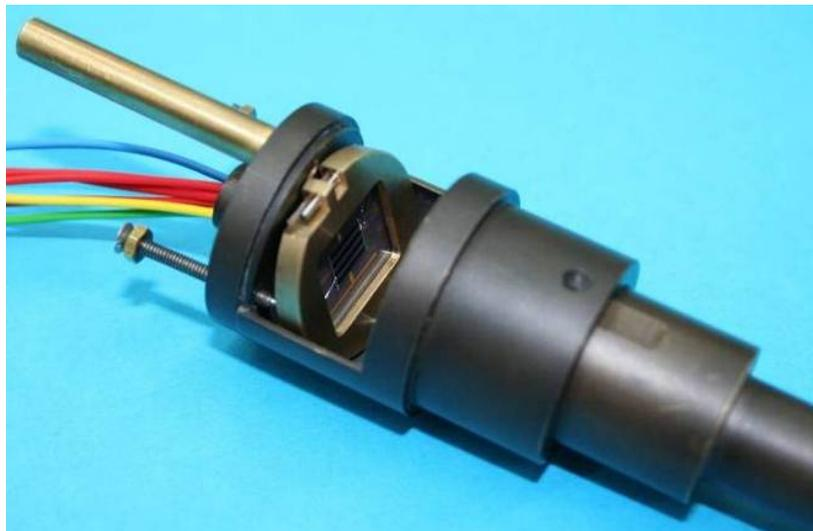
**Abb. 4-9** Blick in das geöffnete Sensorgehäuse auf den PSD-Array-Chip
