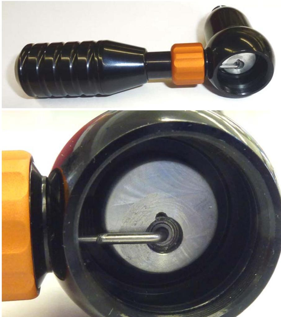
**Abb. 4-11 Vibrationsarmer Kurbeltrieb mit 4,6 mm Hub und reduzierter Pleuelmasse, Variante mit einem Kugellager, oben Prototyp, unten Detailansicht der Kurbel-Pleuel-Baugruppe**
