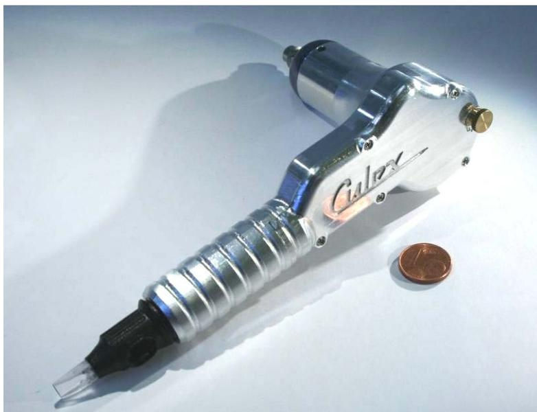
**Abb. 4-35 Fertig aufgebauter Querkurbeltrieb-Aktor im Größenvergleich**
