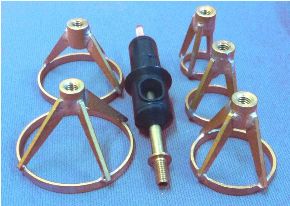
**Abb. 4-104** Durch Modifikation eines Tätowiermoduls aufgebautes Ringmodul mit auswechselbaren Ringvorsätzen unterschiedlichen Durchmessers
