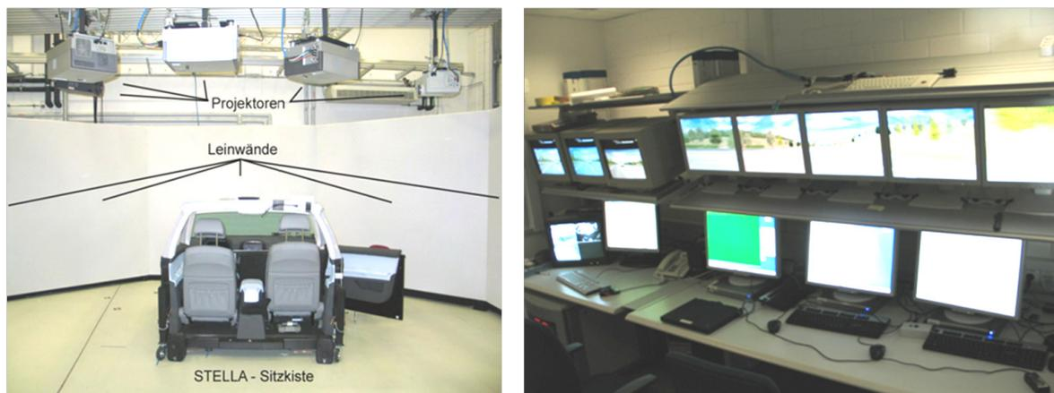
**Abbildung 6.2:** Positionierung Sitzkiste und Monitor-Raum für Versuchsleitung
