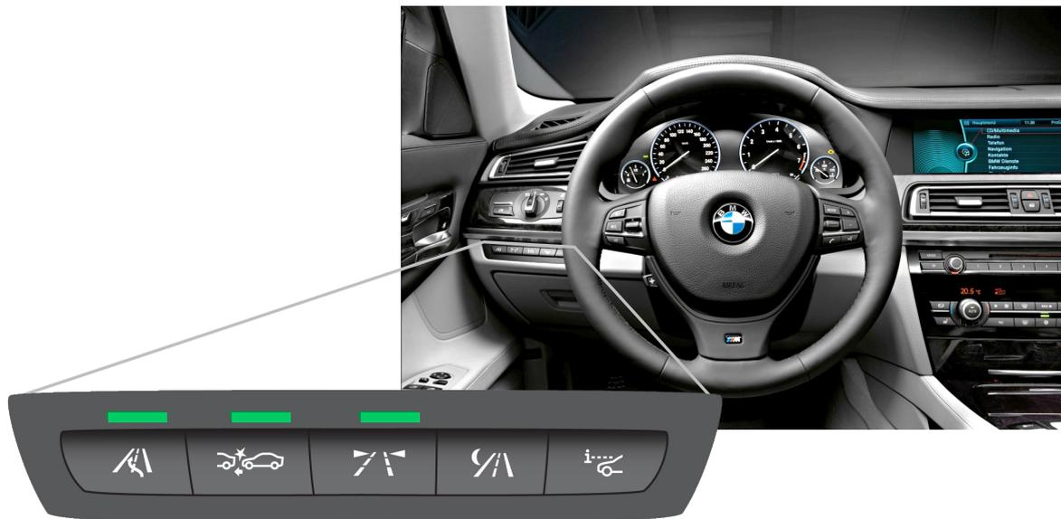
Abbildung 7.1: Fahrerassistenz-Bedienleiste des BMW 7er (BJ 2008)
