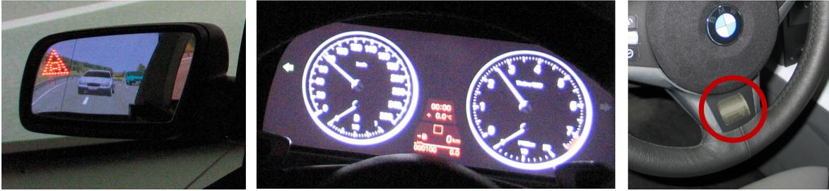
**Abbildung 6.3:** LCA-Außenspiegelanzeige, Kombi und Unwucht-Erreger im Lenkrad
