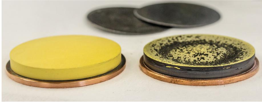
Abb. 16: Neues und gebrauchtes  $\text{In}_2\text{O}_3$ -Target nach ca. 50 h Brenndauer (2"-Durchmesser).
