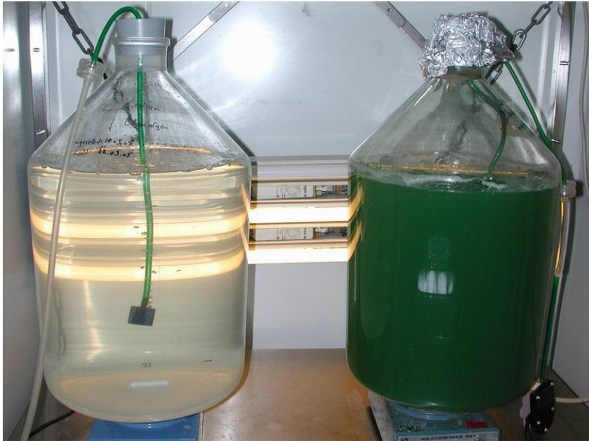
**Bild 3.2:** Algenkultivierung unter klimatisierten Bedingungen; Links: neu beimpfter Ansatz; Rechts: Ansatz am Ende der stationären Phase der Wachstumskurve der Algen (30 Tage) kurz vor der Filtration
