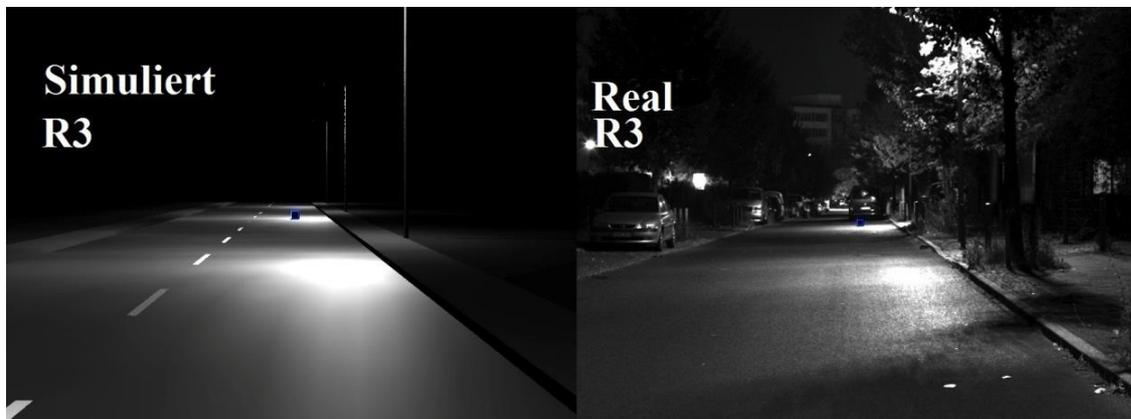
Abbildung 4.6: Vergleich von simuliertem (links) und realem Leuchtdichtebild (rechts) anhand einer in der Simulation nachgestellten realen Beleuchtungsszene.
