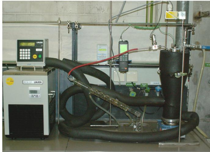
**Abb. 4-4: Laborversuchsanlage zur Bestimmung der Thermostabilität des gereinigten Extraktes**
