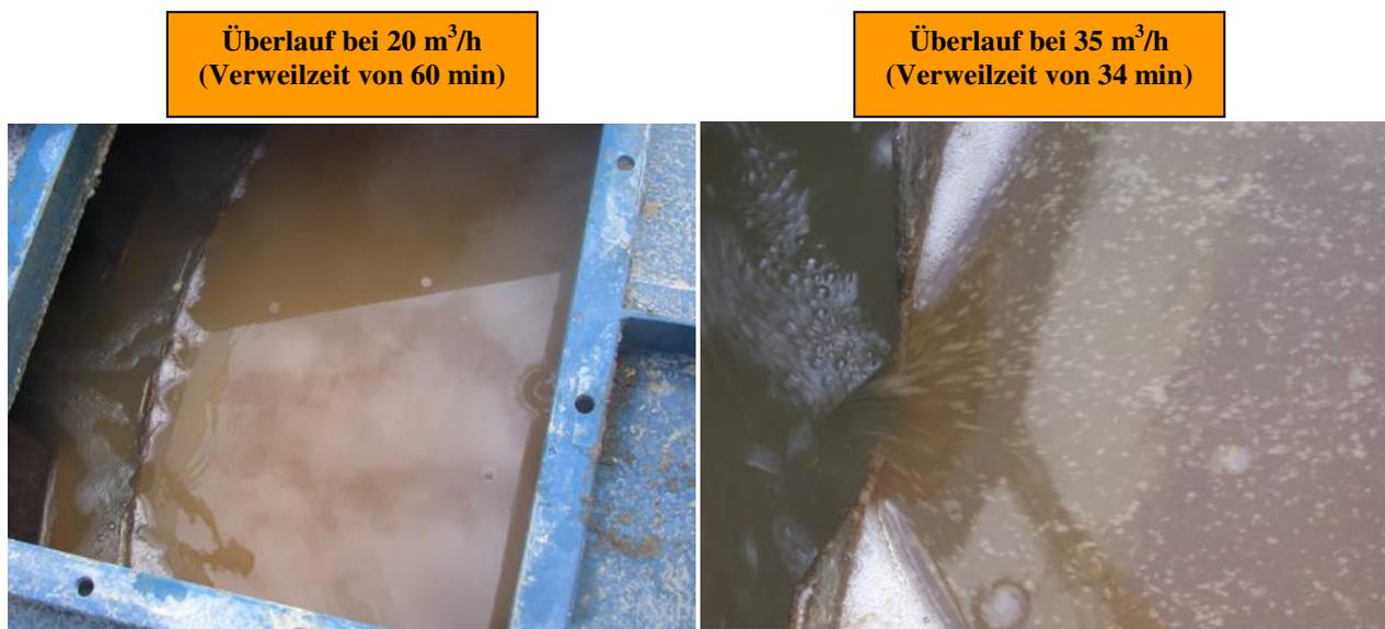
**Abb. 6-20: Trübstoffe im Überlauf des Versuchsdekanteurs bei unterschiedlichen Volumenströmen (Werk C, Kampagne 2004)**
