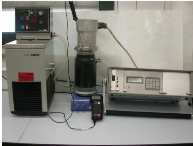
**Abb. 4-5: Versuchsanlage zur Ermittlung der Extraktviskosität mit dem Meßsystem RHEOSWING® RSD 1-1 im Labor**
