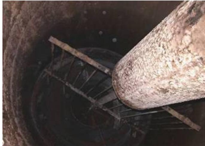
**Abb. 6-3: Versuchsdekanteur (Fa. Dorr-Oliver®) und innerer Aufbau (eine Kammer)**
