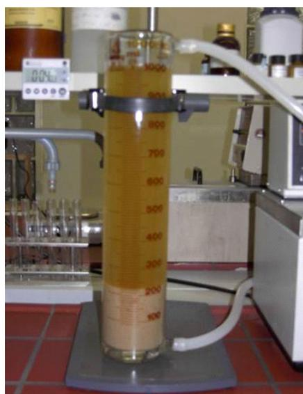
**Abb. 4-6: Temperierbare Laborversuchsanlage mit eingebautem Krählwerk zur Ermittlung des Absetzverhaltens (Fa. Dorr-Oliver)**
