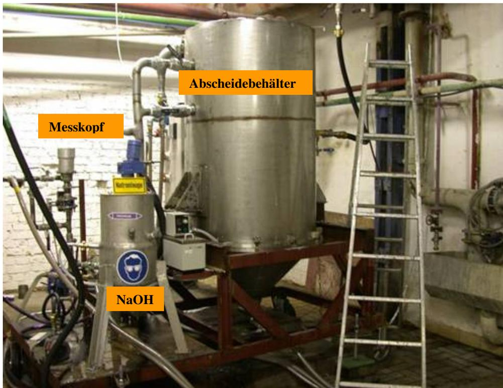
**Abb. 5-14: Versuchsanlage zur kontinuierlichen Bestimmung der Extraktviskosität im Werk B in den Kampagnen 2004 und 2005**
