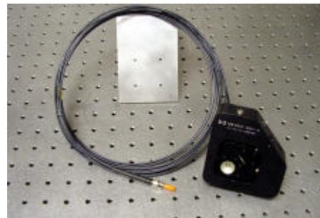
Abb. 4.1: Schematische Darstellung einer kommerziell erhältlichen Faser [4.1] und Foto eines verwendeten Multimode-Quarzglasfaserkabels mit einem Kerndurchmesser von 50 µm und Kopplungselement.
