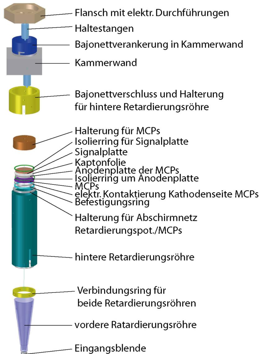
Abbildung 9.2: Explosionsdarstellung eines Flugzeitspektrometers.
