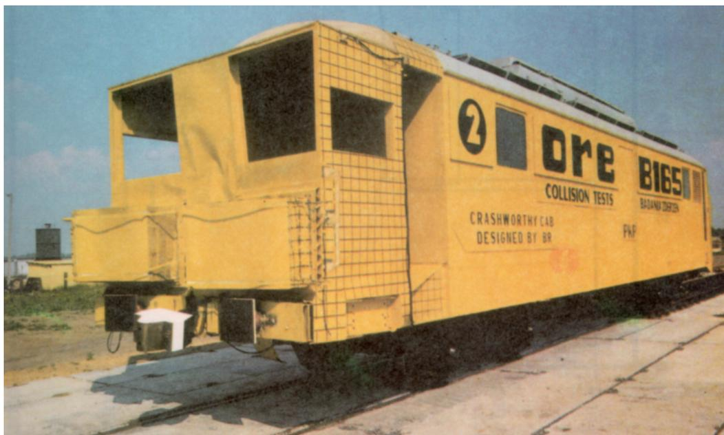
**Abbildung 7.4:** Gestoßenes Fahrzeug nach dem Aufprallversuch [65]
