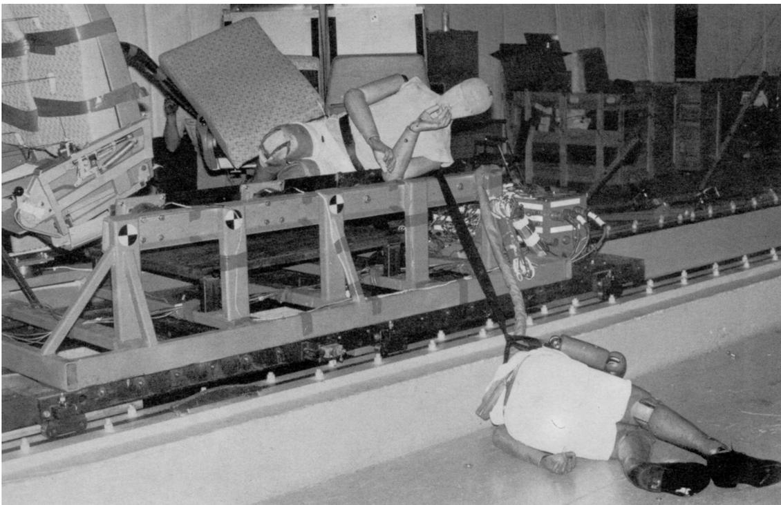
**Abbildung 7.11:** Schlittenversuche mit konventionellen Fahrgastsitzen von Reisezugwagen [75]
