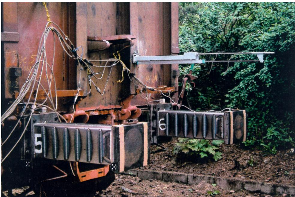
**Abbildung 7.9:** Komponententest mit einem Kastenprofil aus Stahl in Kombination mit einem Kunststoffwabenkern [73]
