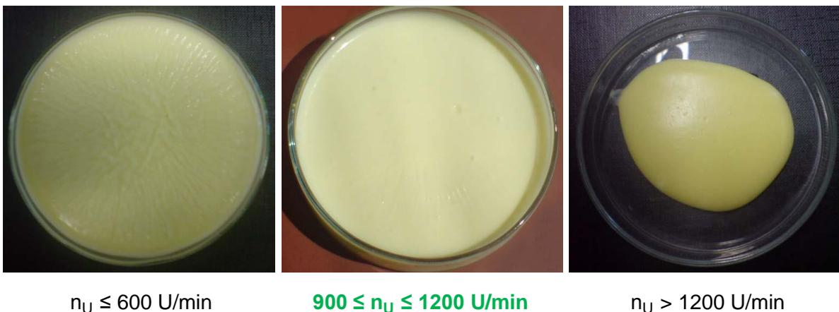
Abb. 8.5 Schmelzkäseproben als Funktion der Rührerdrehzahl
