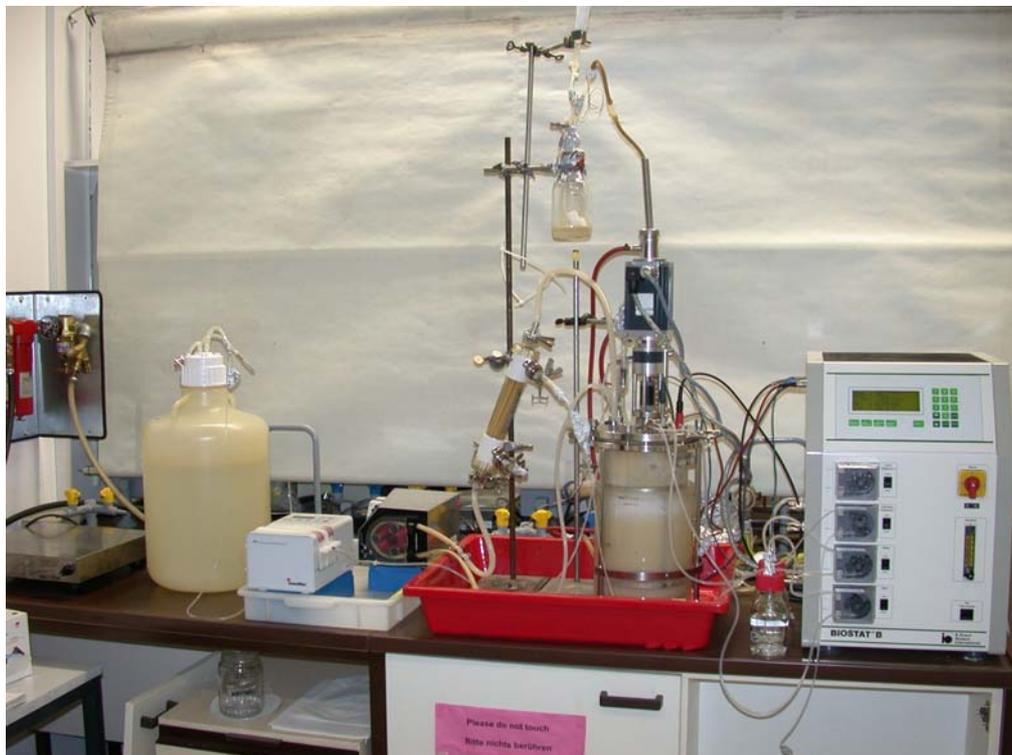
Abb. 6: Membranbioreaktorsystem zur Langzeitkultivierung von *E. coli*
