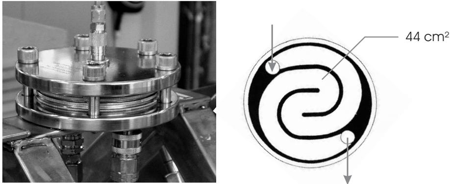
Abbildung 4.11: Crossflow-Testzelle der Fa. Amafilter mit gewundenem Feed-Kanal und 44 cm<sup>2</sup> aktiver Membranfläche.
