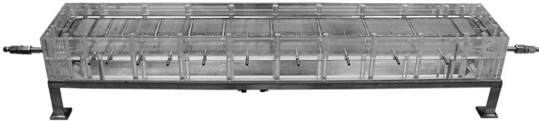
(a) Geschlossene Darstellung der Testzelle ohne den äußeren Stahlrahmen und die Verschraubung.
