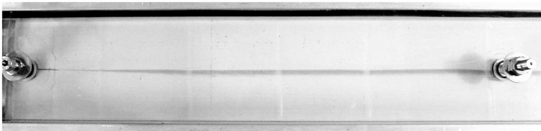
Abbildung 4.6: Eingefärbter Stromfaden bei  $Re \approx 500$  (0,19 m/s) zur Kontrolle von Verwirbelungen und Ablenkungen der Strömung im Einlaufbereich und in der Nähe der Druckmessstellen.
