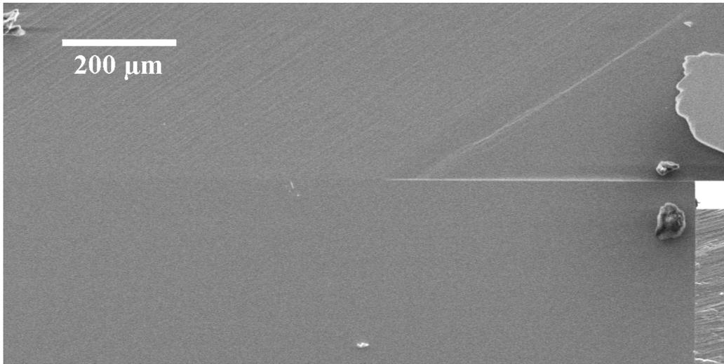
**Abb. 3-17 REM-Aufnahme von GaAs auf GaAs gebonded [Blu13]**
