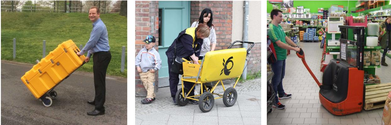
(a) Stechkarre (einachsig, passiv)    (b) Brief-Zustellwagen (mehrachsig, passiv)    (c) Elektrischer Gabelhubwagen (mehrachsig, aktiv)
