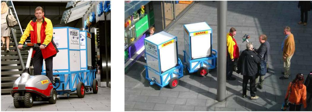
Abbildung 5.1: Feldversuch mit „MicroCarrier Urban Vehicle“ (MCUV) der ersten Generation
