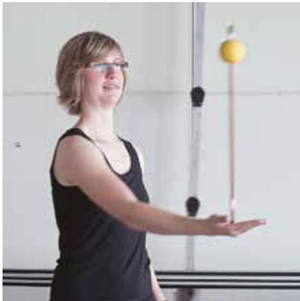
Einen Bleistift auf einem Finger zu balancieren ist nicht so einfach. In Versuchen mit verschiedenen Stäben kann bei uns jeder diese Erfahrung selbst machen. Unser Experiment zeigt, wie man mit Hilfe der Regelungstechnik sogar drei Stifte übereinander balancieren kann.
