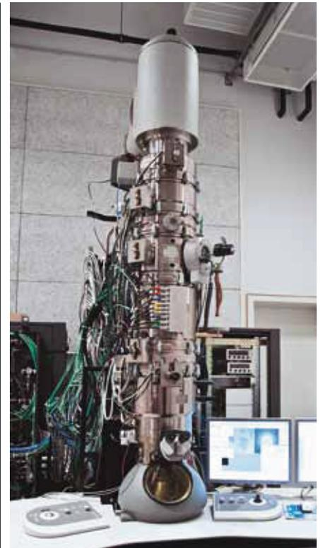
Das Besondere an diesem Transmissionselektronenmikroskop ist, dass es für die Methode der Elektronenholografie elektronenoptisch optimiert und damit weltweit einzigartig ist
