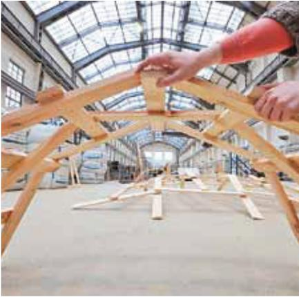
Große Spannweiten zu erzielen ist eine wichtige Aufgabe des Bauens. Durch geschickte Anordnung von kurzen Holzbalken entstehen Flächentragwerke ohne jegliche Verbindungsmittel. Das Modell der Kuppel aus Eisstielen hat Abmessungen von circa 35 mal 35 Zentimetern. Bauen Sie es ohne Zuhilfenahme von Verbindungsmitteln in zehnfacher Größe nach!
