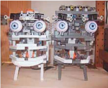
**NEU!** Mit dem „Uncanny Valley“ wird ein auf den ersten Blick widersprüchlicher Effekt beschrieben. Dieser besagt, dass menschenähnliche Roboter befremdlicher wirken können als menschenunähnliche. Anhand zweier interaktiver Roboterköpfe werden der Effekt sowie relevante Gestaltmerkmale gezeigt.
