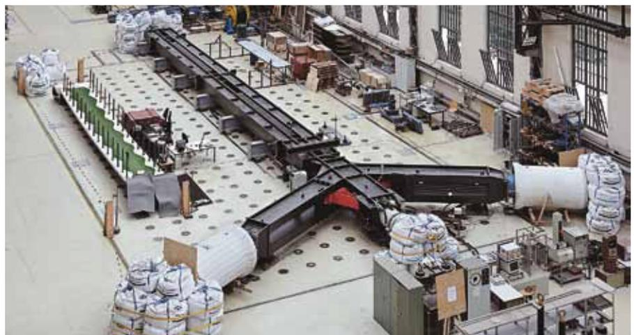
Dynamische Prüfung eines Umlenksattels
