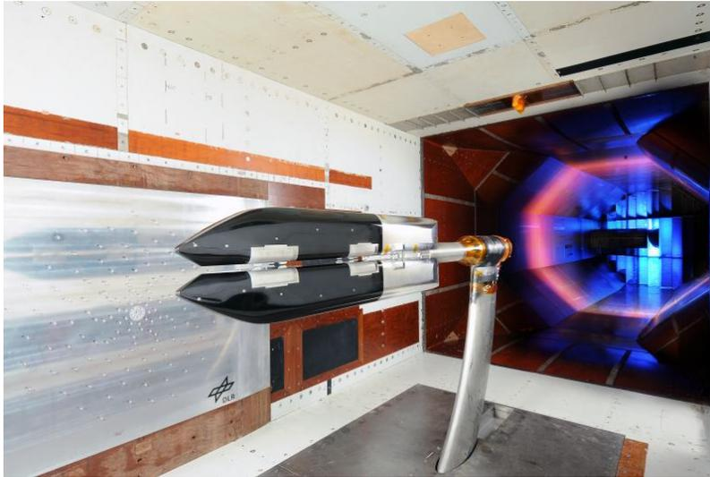
Abbildung 3.5: Der Aufbau in der Messstrecke des DNW-KKK. Im Vordergrund befindet sich das Doppelmodell des NGT2. Auf der linken Seite befindet sich das an der Wand montierte Mikrofonarray.
