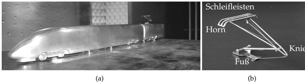
Abbildung 3.7: (a): Das ICE3 Modell im Maßstab 1:25 mit den für die Aeroakustik relevanten Details, wie Drehgestelle, Wagenübergang zwischen Endwagen und der BWA und dem optionalen Pantographen. (b): Nahaufnahme des Pantographenmodells.
