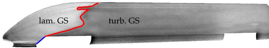
Abbildung 4.12: TSP-Temperatursignatur des ICE3-Endwagens, bei einer Reynoldszahl von  $Re = 0,500 \times 10^6$ . Die hellen Bereiche deuten auf eine laminare, und die dunklen auf eine turbulente Grenzschicht (hier durch "GS" abgekürzt) hin. Die Bereich der Transition ist durch eine rote Linie markiert, und die Vorderkante des Radkastens ist durch die blaue Linie hervorgehoben. Die Strömung kommt von links. Quelle: Fey et al. [59].
