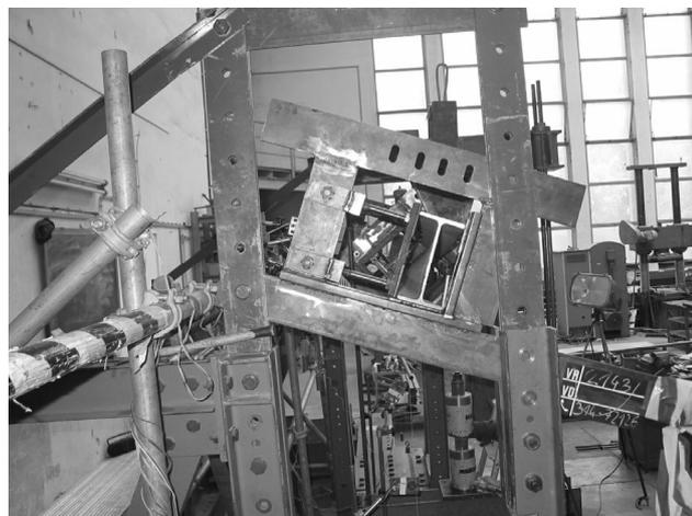
Bild 4.2-5 Auflagerungen der Versuchskörper hier: IPE 200
