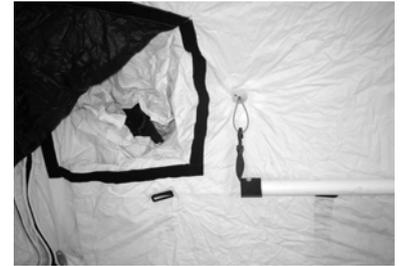
Abb.4.77 Innenmembran mit Ausgang für Versorgungsleitungen. *Quelle: Draeger.*
