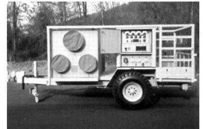
Abb.4.78 HP-2C Trailer. Service-Trailer dienen als mobile Versorgungseinheiten. *Quelle: DHS Systems.*
