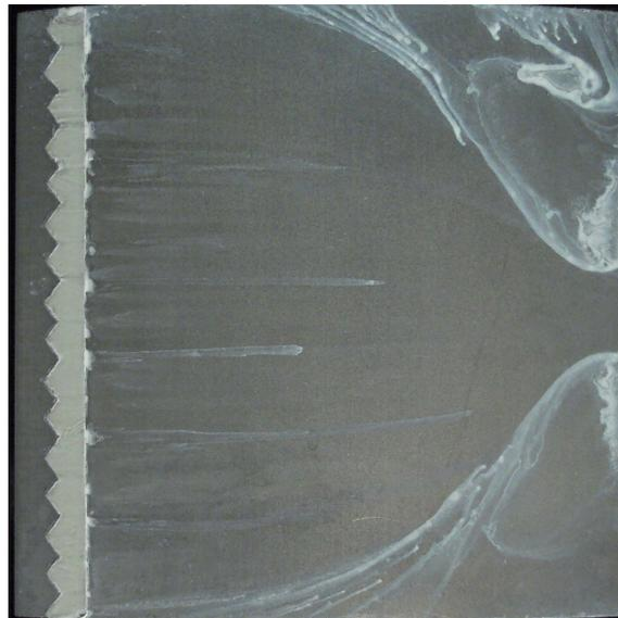
(b) Ölanstrichbild der Referenzkaskade mit Turbulator an der Vorderkante, Strömung v.l.n.r.
