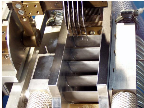
Abbildung 4.2: NACA65 Kaskade mit eingebauter Absaugvorrichtung
