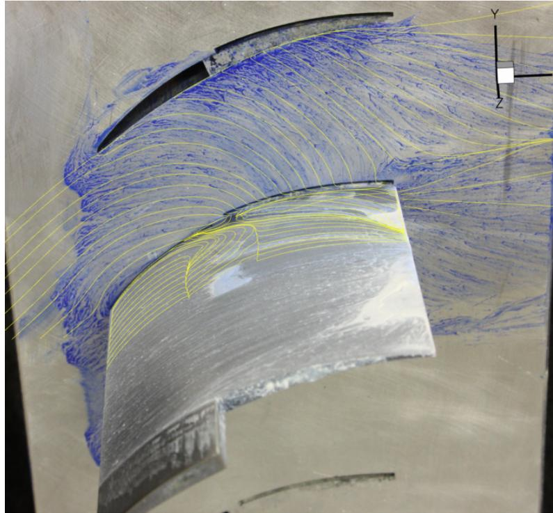
Abbildung 6.2: Visualisierung von Wandstromlinien experimentell und numerisch am Gitter mit Peacock Schlitz im ADP (C.Gmelin [26])
