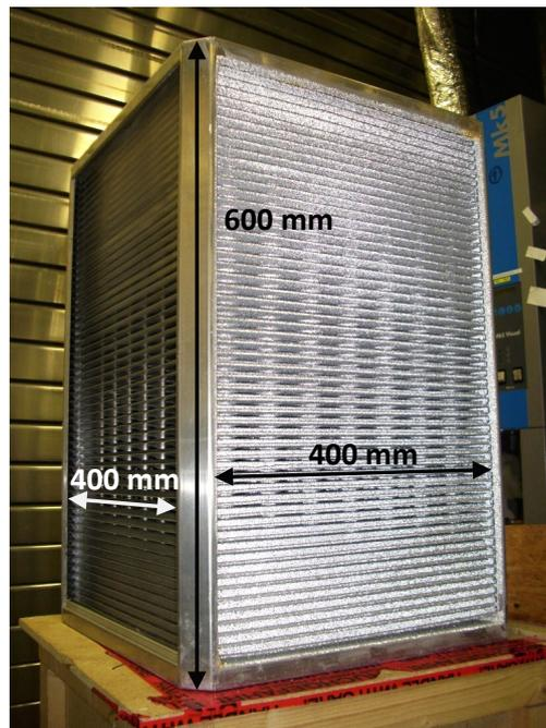
Abbildung 3.6.: Prototyp II mit Silikagel-Expoxidharz-Beschichtung: Sicht auf die mit Silikagel Grace 123B sorptiv beschichteten Kanäle (hell im Bild).
