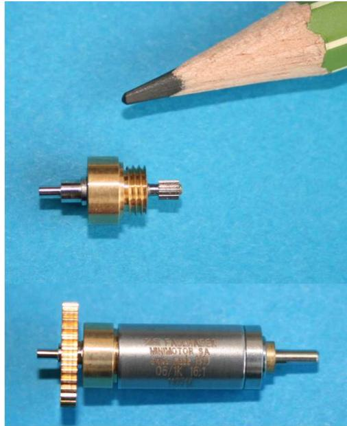
**Abb. 8-15** Getriebeflansch mit der Wellenlagerung (oben) und komplette Getriebeeinheit (unten) [Matz10]
