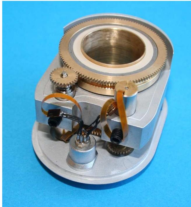
**Abb. 8-11** Aufsteckadapter mit den Namiki-Motoren vor der Montage des Gehäuses
