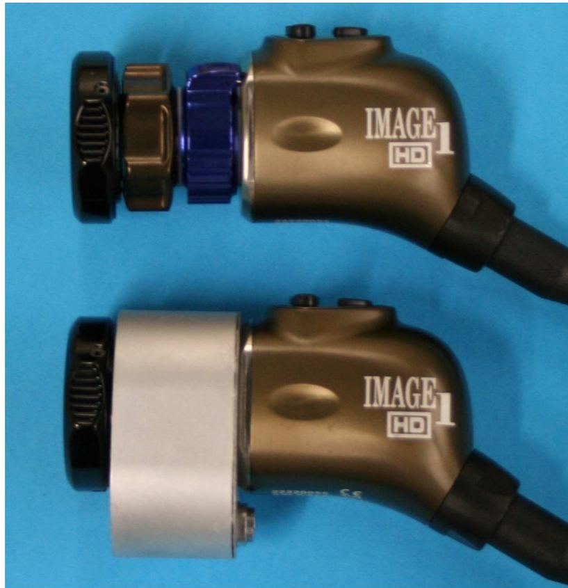
**Abb. 8-12 HD-Kamera ohne (oben) und mit Automatisierungsaufsatz (unten)**
