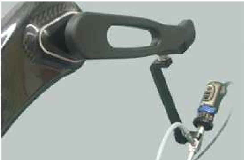
**Abb. 9-1** Einsatz eines motorisierten Haltearms der Firma AKTORmed GmbH bei einer laparoskopischen Operation (oben), Haltearm mit der Endoskopkamera und einem starren Endoskop (unten) [Akto10]
