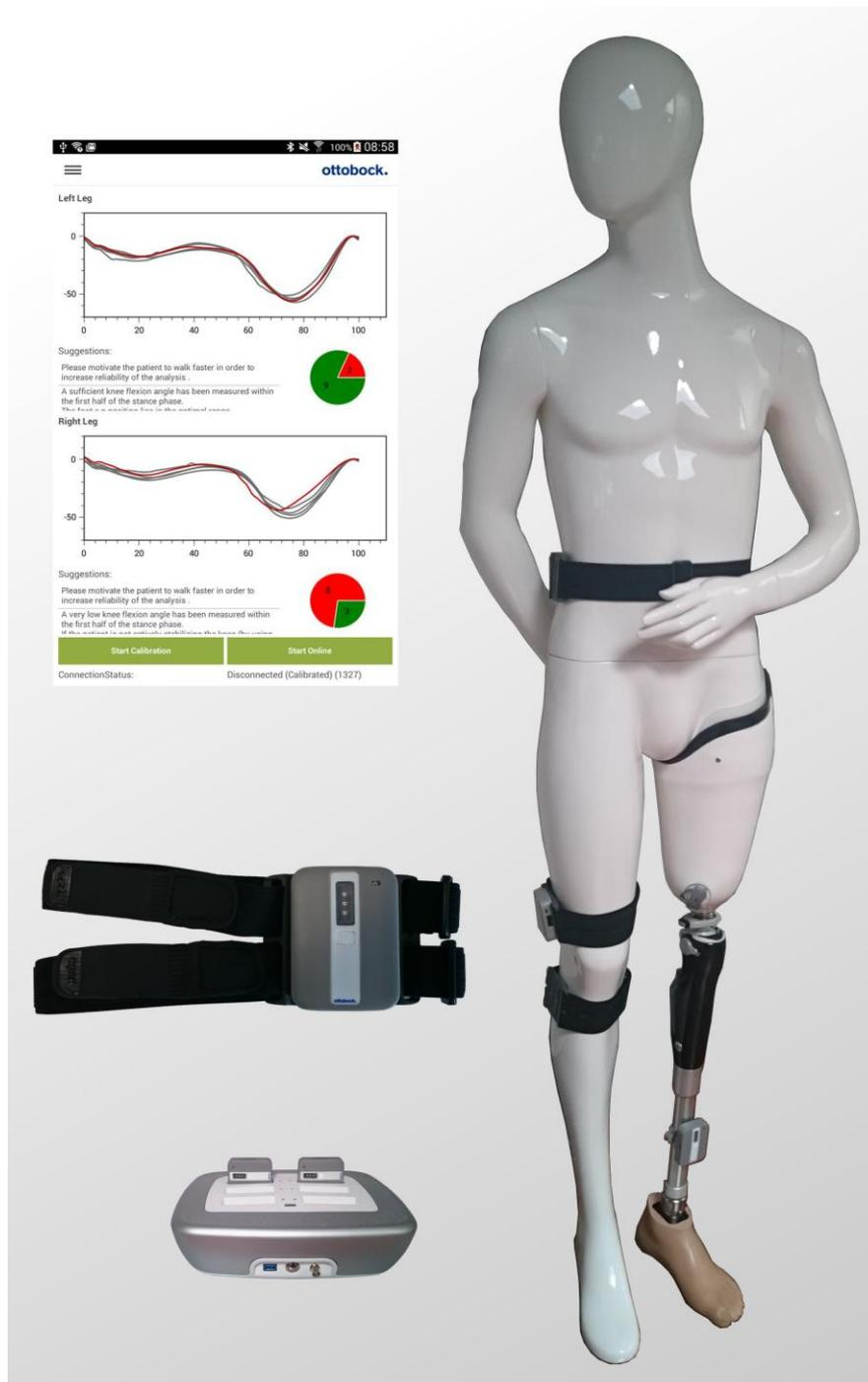
Abbildung 4 Entwickelter Demonstrator, rechts: Anbringung der Sensoren an Gliedmaßen und Prothese, links unten: Basisstation mit zwei Inertialsensoreinheiten, links Mitte: Inertialsensoreinheit mit Gurtsystem, links oben: Beispielausgabe der Expertensoftware auf dem zugehörigen Tablet
