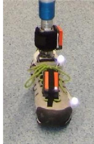
Abbildung 17 Ideale Sensorposition auf dem Schuh mit Sensorkoordinatensystem (links), tatsächliche Anbringung eines Inertialsensors und der Ganganalysemarker (rechts)
