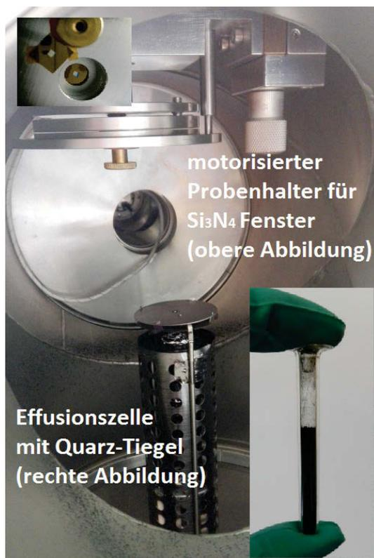
Abbildung 6.6: Die Verdampfungskammer mit der Effusionszelle und dem Probenhalter für Si<sub>3</sub>N<sub>4</sub>-Fenster. Der Abstand zwischen Probe und Tiegel in der Effusionszelle beträgt etwa 10 cm. Inset: Draufsicht auf den Probenhalter mit eingebauten Si<sub>3</sub>N<sub>4</sub>-Fenstern.
