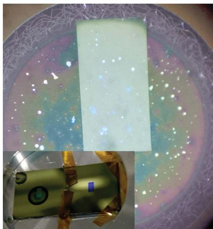
Abbildung 6.4: Gezeigt ist ein eingetrockneter Tropfen der Cu-Chlorophyllin Lösung auf einem  $\text{Si}_3\text{N}_4$ -Fenster und ein leeres Referenzfenster auf einem Probenhalter (Inset). In dieser Konfiguration wurde die Probe im Laboraufbau mit der LPQ vermessen. Die Mikroskopaufnahme zeigt die nicht homogene Eintrocknung der Flüssigkeit. Die resultierende inhomogene Schicht weist sowohl Kristallisation an den Rändern auf, als auch Konglomeratbildung von Cu-Chl.
