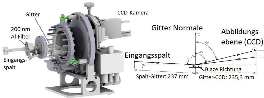
Abbildung 3.4: Reflexionsgitterspektrograph für ein VLS-Gitter der Firma Hitachi (rechts). Die maximale Abmessung des Spektrograph vom Eintrittsspalt bis zum CCD-Kamera beträgt weniger als 50 cm und kann den spektralen Bereich von 250 eV bis 1,2 keV abbilden.
