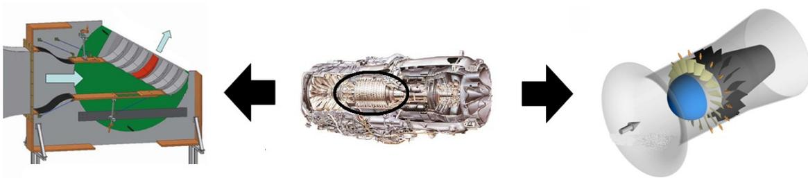
**Abbildung 3.4. Statorkaskade und Axialventilator als repräsentative Konfigurationen einer Verdichterstufe.**
