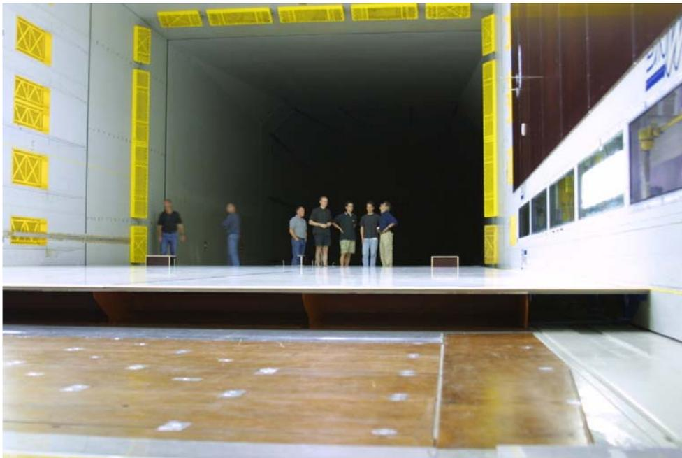
ABBILDUNG 3.1: Versuchsaufbau am DNW: rechts oben – Mess-Stelle Seitenwand (braun), mittlerer Bildbereich – Mess-Stelle Platte (weiß)
