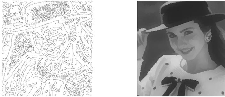
**Abb. 4.5:** Kantenbild und segmentiertes Bild ohne Schwellwert zur Rauschunterdrückung bei der Erkennung von Nulldurchgängen
