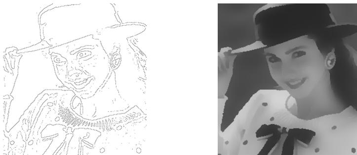
**Abb. 4.6:** Kantenbild und segmentiertes Bild nach Einsatz eines Schwellwertes bei der Erkennung von Nulldurchgängen
