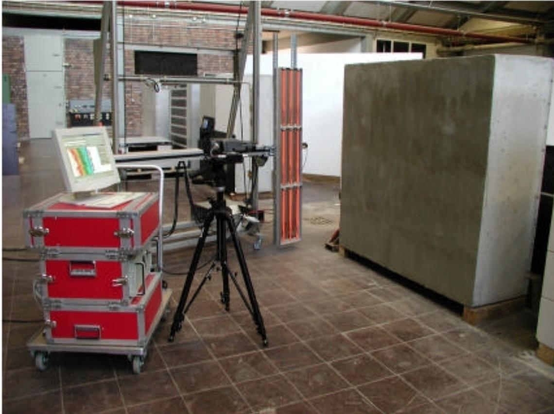
**Abbildung 4.1** Experimenteller Aufbau für die Impuls-Thermografie im Bauwesen
