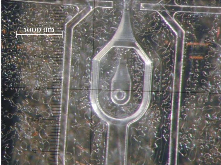
Abbildung 4.11: Eingeschlossene Luftblasen in der Fügeebene eines mittels Transferklebens gefügten Analysechips
