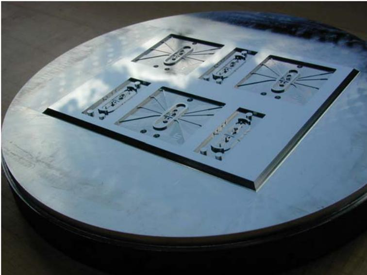
Abbildung 4.6: Ultra-präzisionsgefräster Formeinsatz (Ø 100 mm) zum Heißprägen thermoplastischer Kunststoffe
