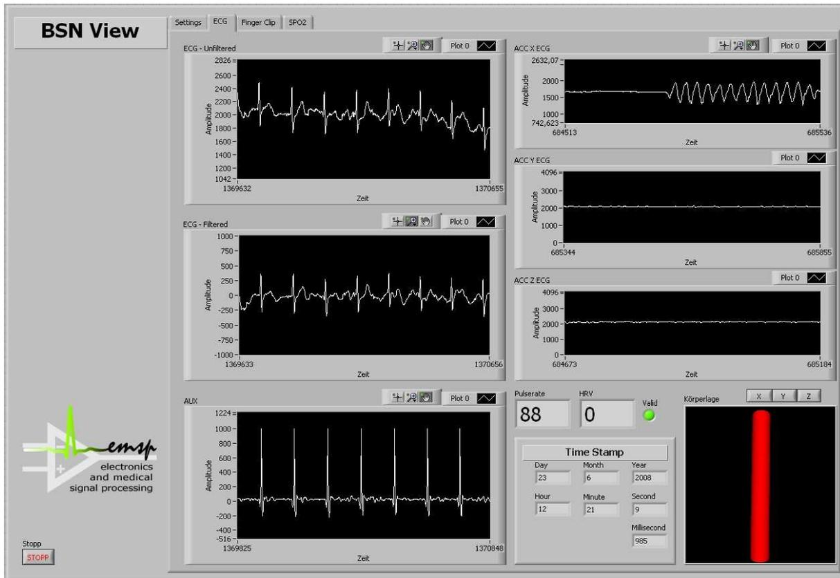
Abbildung 3.20.: Benutzeroberfläche zur Visualisierung der EKG- und Beschleunigungs-Messdaten am Rechner.
