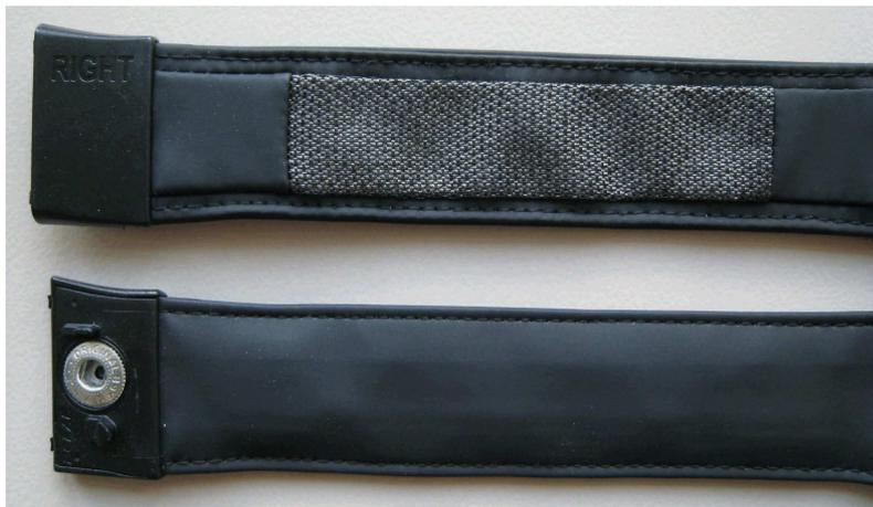
**Abbildung 5.9.:** Textile Elektrode der Firma Polar. Oben: innenliegendes leitfähiges Gewebe (20 mm x 80 mm), eingearbeitet in einen textilen Träger. Unten: Druckknopfanschluss an der Außenseite.
