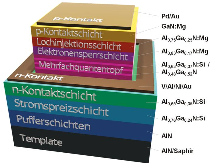
Abbildung 3: Schematische Darstellung der Heterostruktur einer 265 nm LED.
