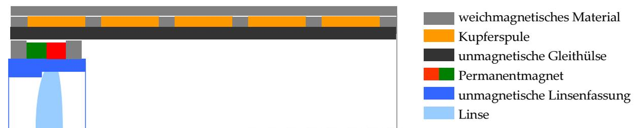
**Abbildung 7-16 Aufbau für einen elektromagnetischen Linearantrieb, der sich in verschiedene Positionen verfahren lässt**
