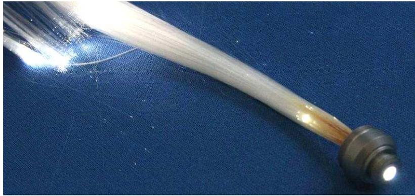
Abbildung 5-6 Gebrochene Fasern an der Biegestelle
