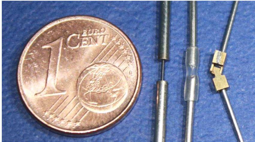
Abbildung 3-22 NiTi-Gelenke, Polymergelenke, Kardangelenke,
