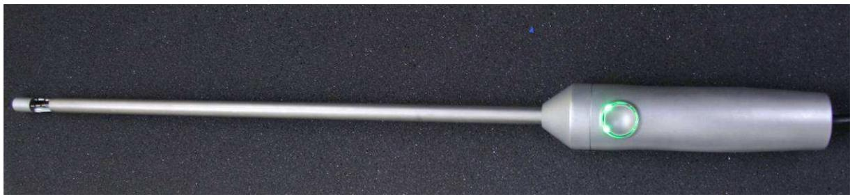
Abbildung 5-11 Dritter Aufbau mit Joystick zur Spitzensteuerung im Handgriff
