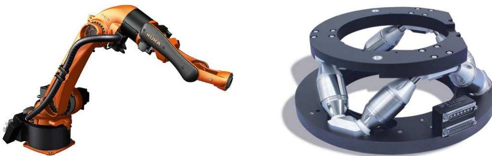
**Abbildung 2-2** Industriebeispiele für serielle Kinematik [Kuka10], links und parallele Kinematik [Phys10], rechts
