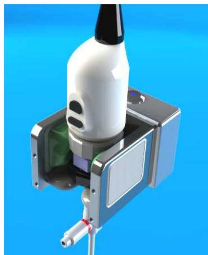
**Abbildung 6-4 Optimierte Halterung als CAD-Modell**
