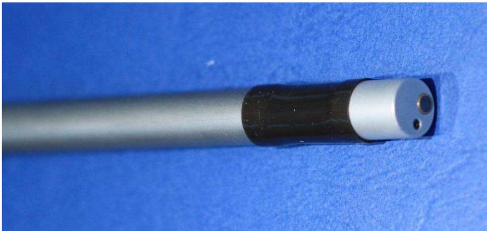
**Abbildung 3-37 Labormuster mit aufgeschobener Silikonhülle**
