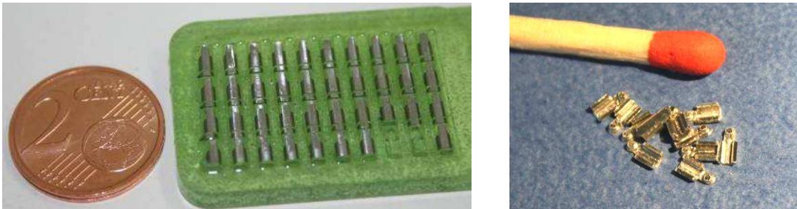
**Abbildung 3-12 Gelenkteile aus V2A in Technovit vor und nach dem Auslösen in Aceton**
