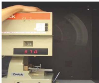
Abb. 7.10: Pendelschlagwerkmaschine der Firma „Zwick Model S102“
