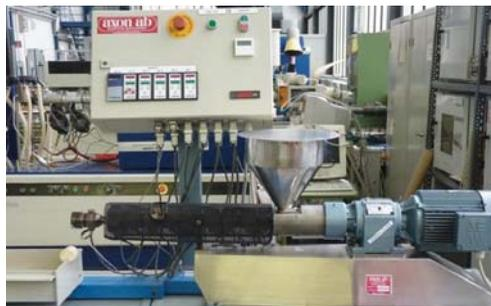
Abb. 7.2: Einschneckenextruder der Firma Axon Modell „S-265 00 ASTORP“
