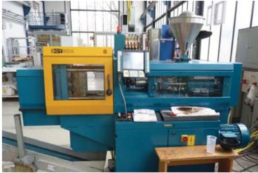
Abb. 7.4: Spritzgießmaschine der Firma „Boy Typ 30A“
