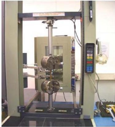
Abb. 7.7: Zugprüfmaschine der Firma „Zwick Modell 63336/101“.
