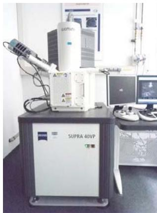
Abb. 7.11 Rasterelektronenmikroskop der Firma „Zeiss Modell Supra 40 VP“
