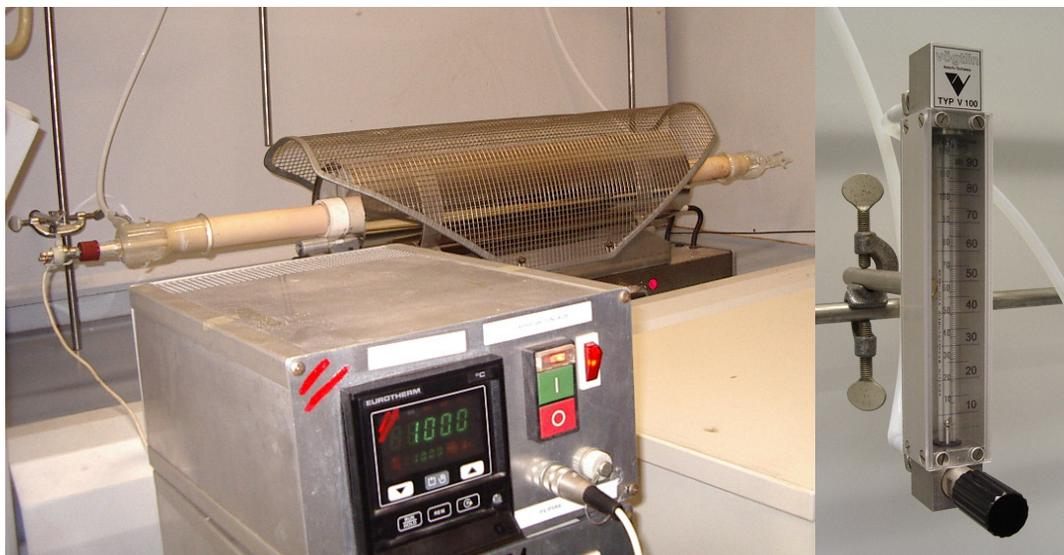
**Abb. 13:** Rohrofen mit Regler (links) und Durchflussmesser (rechts)
