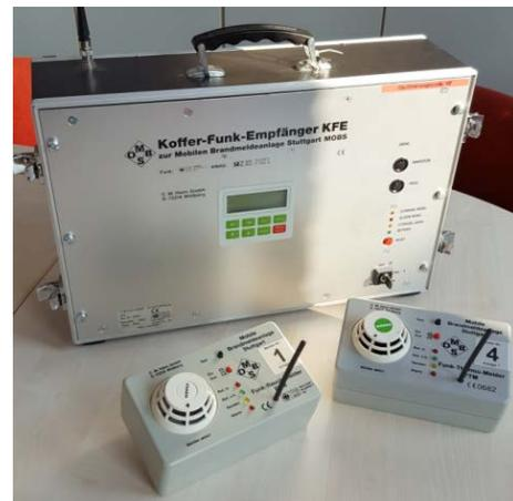
Bild 42: Mobiles Brandmelde-System MoBS
