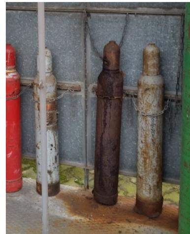
Bild 34: Teurer Altlastenfund - Stark korrodierte Gasflasche mit Chlorwasserstoff
