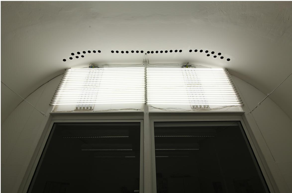
Abbildung 87: künstlicher Himmel mit 40 Leuchtstofflampen vom Typ T5 865 80 W
