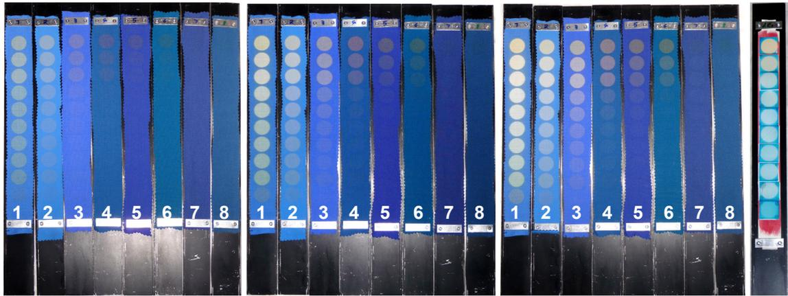
Abbildung 25: Blaumaßstäbe 1-8 nach der 10., 14. und 17. Bestrahlungsperiode (175, 764 und 1450 Stunden) und LightCheck® Sensitive nach der 17. Bestrahlungsperiode (1450 Stunden)
