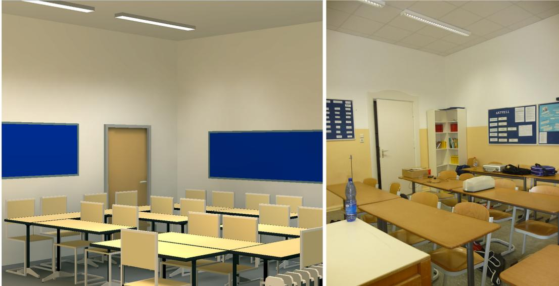
Abbildung 8: Neue energieeffiziente Beleuchtung im Klassenraum (Altbau), Simulation und Realraum
