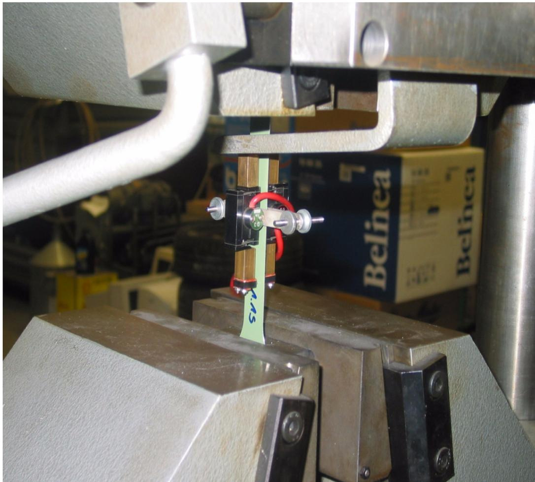
**Bild A.2** Eingespannte Zugprobe in der Prüfmaschine
