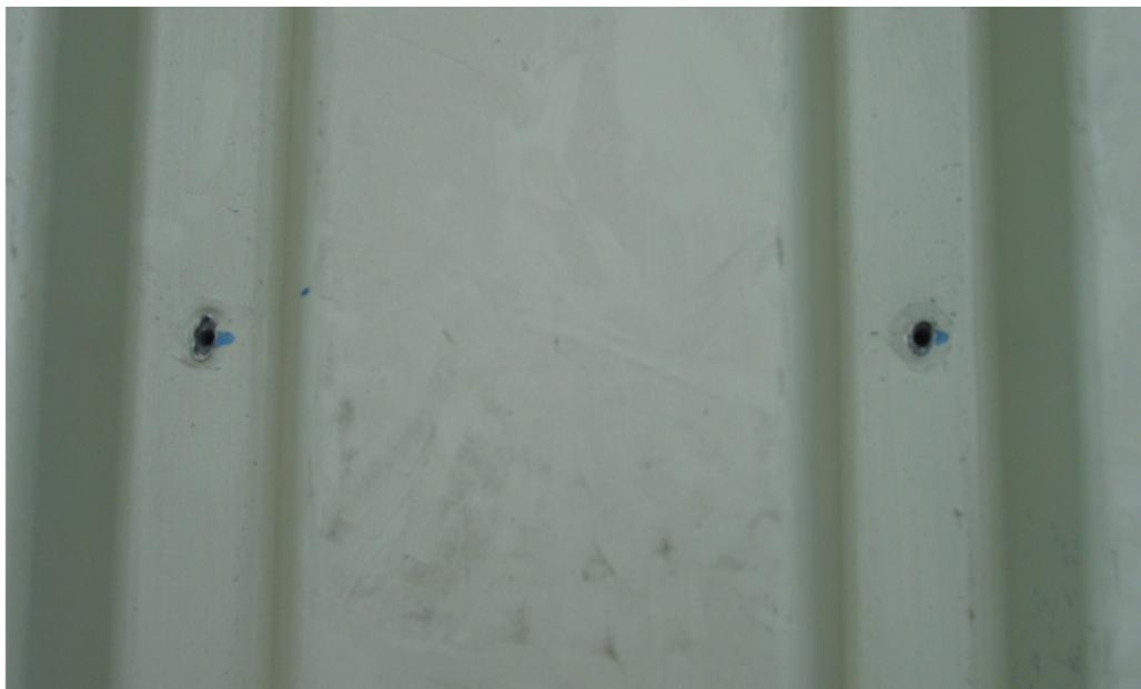
**Bild A.13** Langlochbildung infolge des Versuchs
