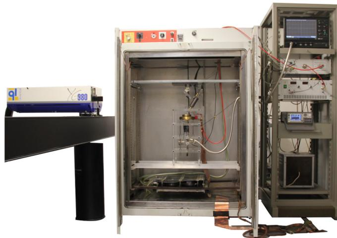
Abbildung 3.3: Foto des Versuchsaufbaus mit Puls laser auf der linken Seite, Temperaturkammer mit Messzelle in der Mitte sowie Steuergeräten, Spannungsquelle und DSO auf der rechten Seite
